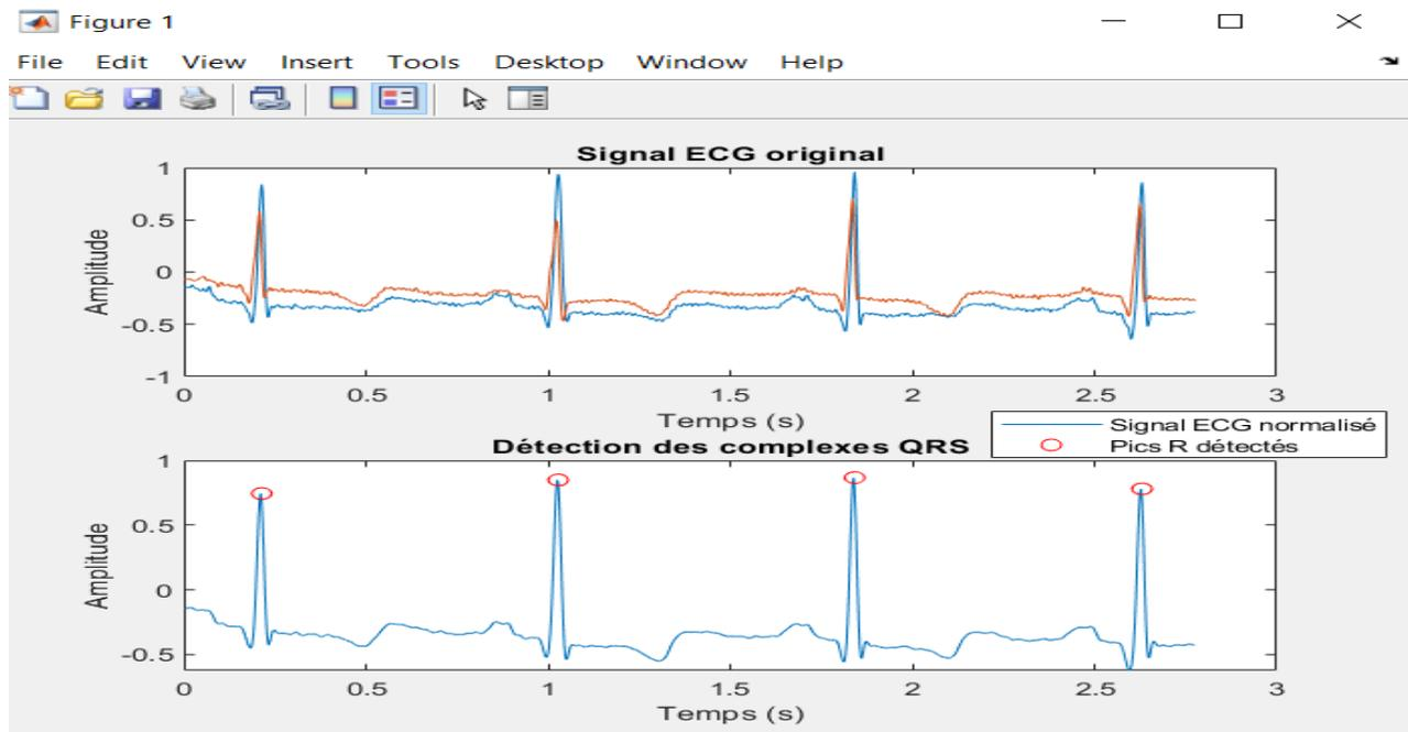
**Figure III.4** : Détection complexes QRS du signal ECG
