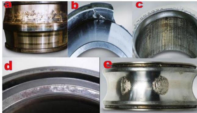
Figure 1.8 : Exemples de défaillances affectants les roulements ; a: grippage, b:fractur, c:usure de contact, d: corrosion de contact, e: écaillage de bague interne.
