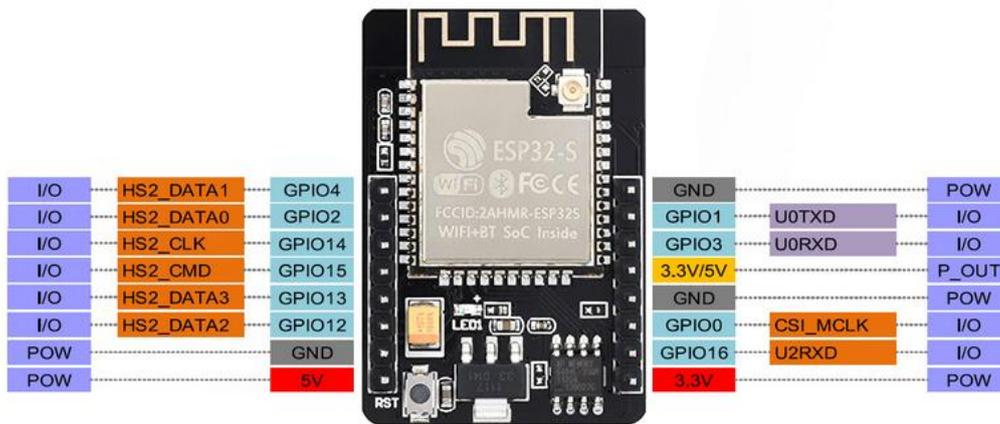
Figure II.4 différentes broches de l'ESP32-CAM
