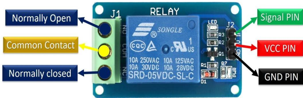
Figure III.15 Description du module relai 5V
