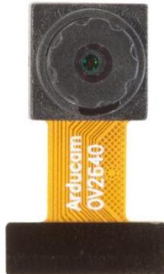
*Figure II.3 Module de caméra ArduCAM OV2640*
