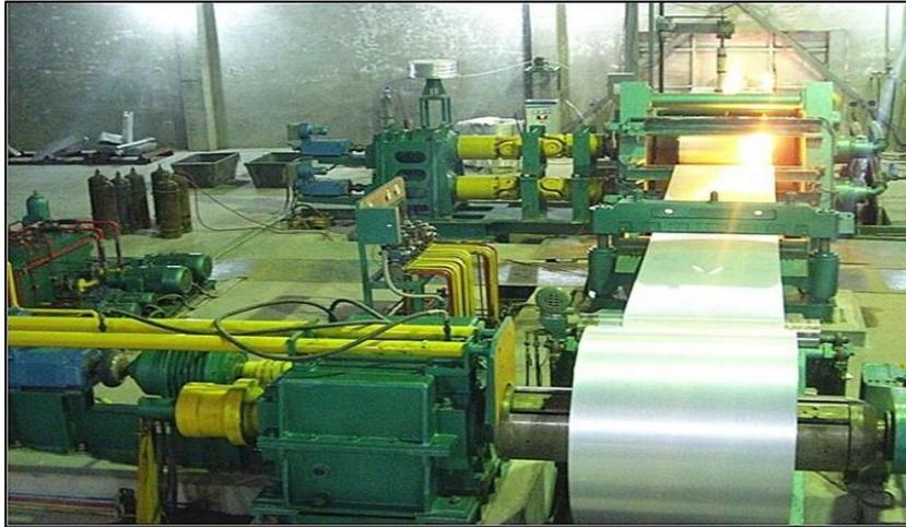
Figure I. 5 : laminage à froid
