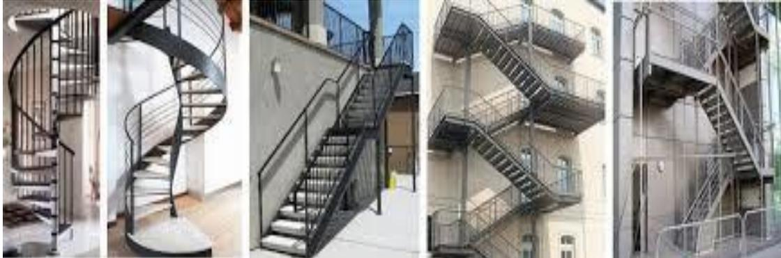
**Figure 1.4 :** Escaliers en charpent métallique.
