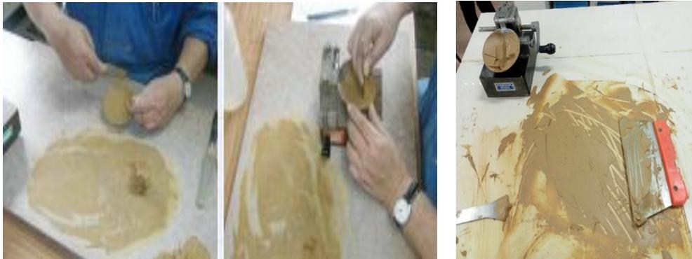
Figure IV.11 : Remplissage de la coupelle et réalisation de la rainure
