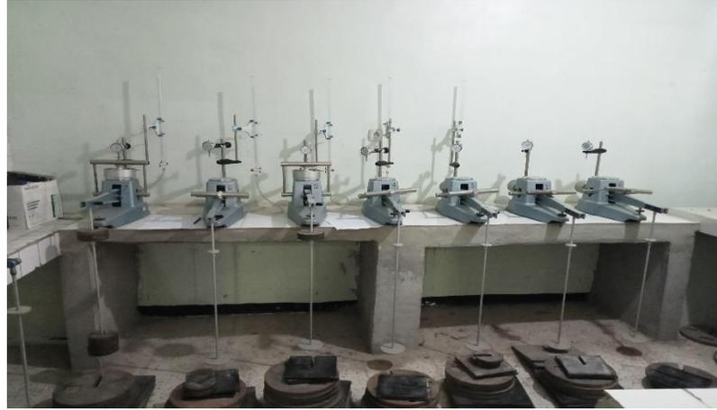
**Figure: IV.20 :** appareil odométrique
