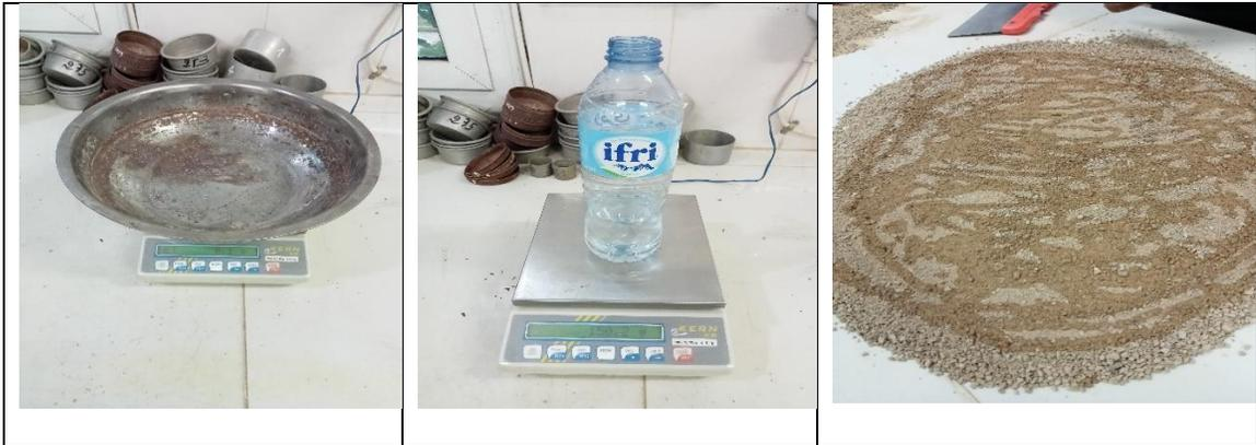
Figure IV.17 : Mélangez l'échantillon de sol sec avec différentes quantités d'eau
