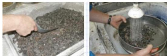
**Figure IV.6 :** Lavage à 80 µm
