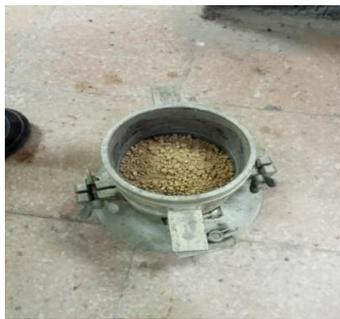
Figure IV.18 Mise en place dans moule
