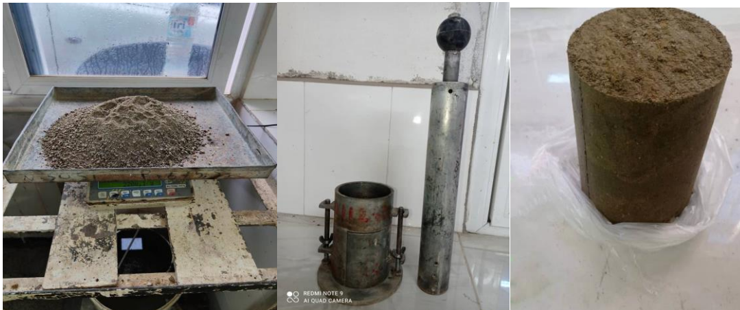
Photo 2.12 : l'essai Proctor pour sol sans additives dans laboratoire(LTPE. Annaba)
