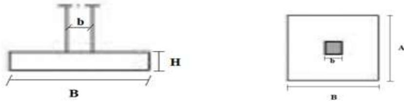
**Figure VIII.2 :** Section d'une semelle isolée.
