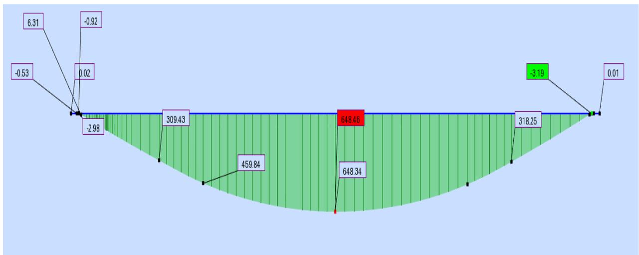
Figure 2. 17 le moment max a l'ELU sous la charge
