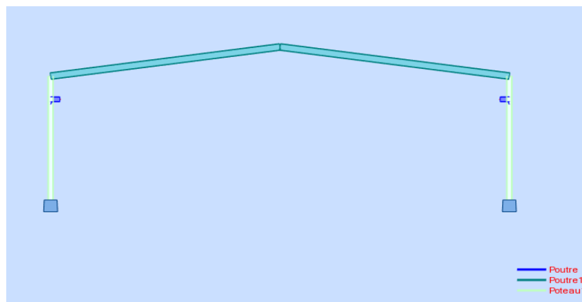
Fig VI .1 : Vue de face du portique.
