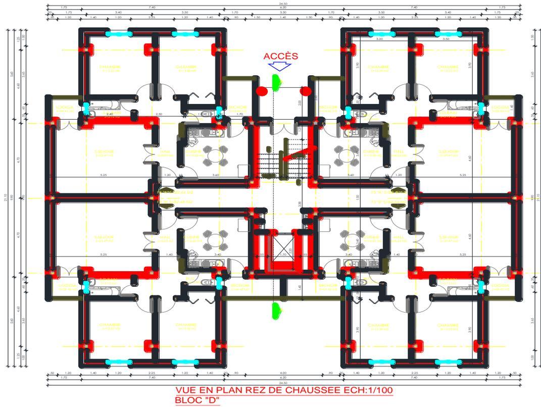
Figure I.5 : vue en plan rez de chaussée Ech : 1/100 Bloc 'D'
