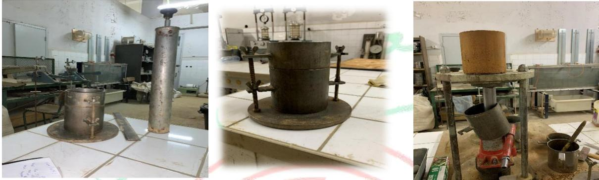
**Figure 5.8:** Dames, moule CBR et Proctor, Extracteur manuel pour essai de compactage.
