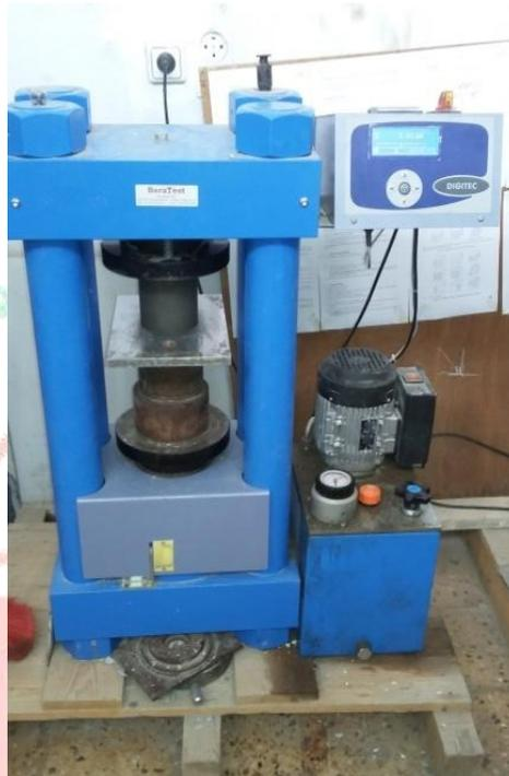
**Figure5.9:** Presse mécanique Beta Test model YIM108C
