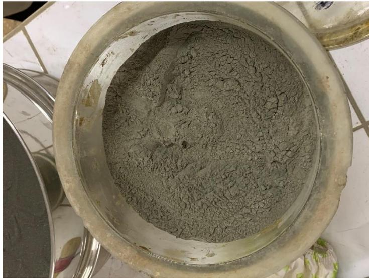
**Fig. 4.8** .poussière du four ciment passant au tamis 0,08 mm
