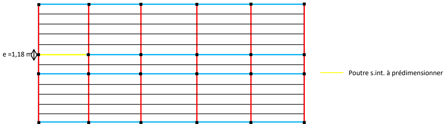
Figure III. 8 poutres secondaires intermédiaires à prédimensionner
