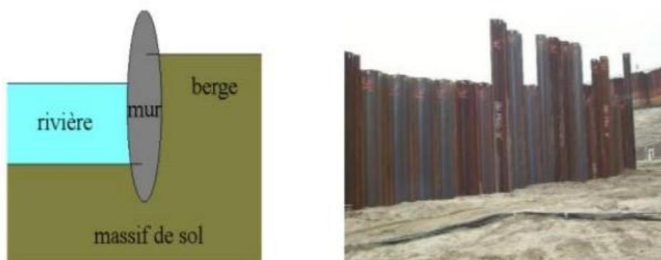
Figure I.5 : a):schéma de principe du mur de palplanches ; b) Assemblage des éléments
