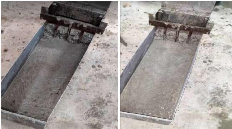
Figure.III.9.Essai de boîte en L pour BAP.FM 1(blocage)
