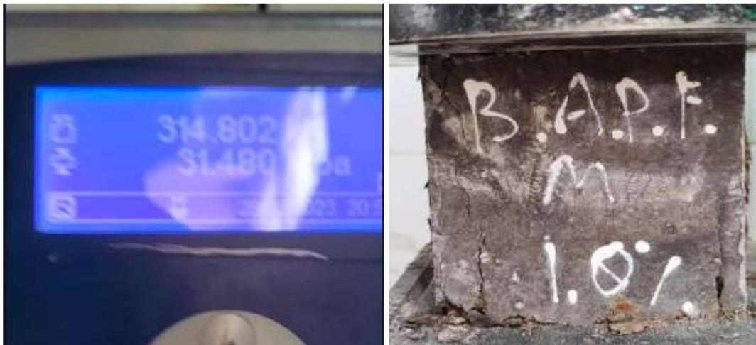
Figures III.28.Essai de compression pour BAPM exposé à haute température (600C°)
