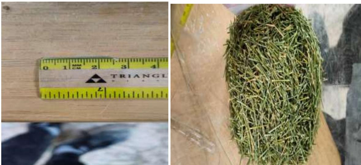
**Figure II.10 : Fibre végétales Halfa de 2.5 cm**
