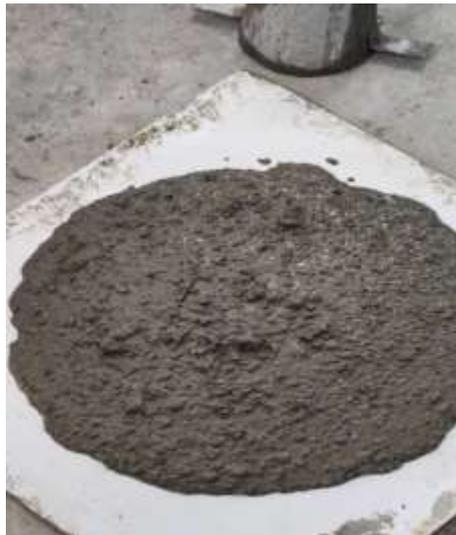
**Figure III.1. Essai d'étalement de B.A.P (témoin)**
