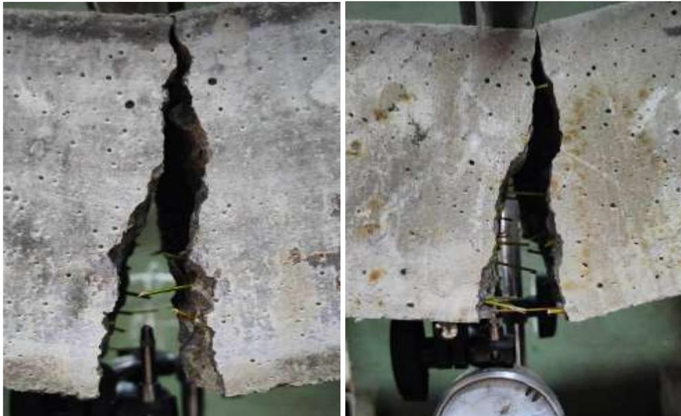
**Figure III.44: Mode de rupture en flexion des BAPFV**
