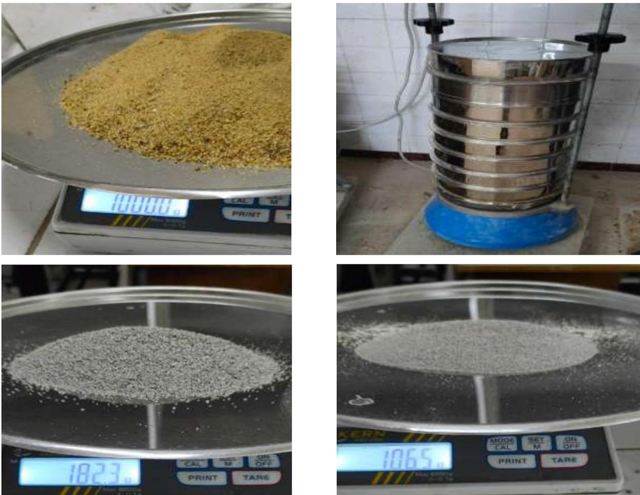
Figure II.3 : Image de l'analyse granulométrique des sables utilisés
