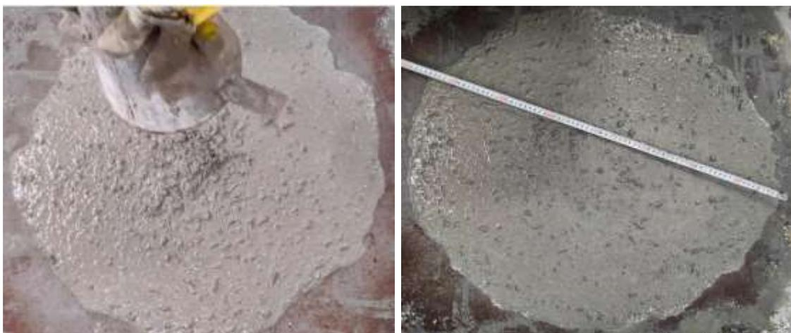
**Figure. III.4. Essai d'étalement de BAPF.M1**
