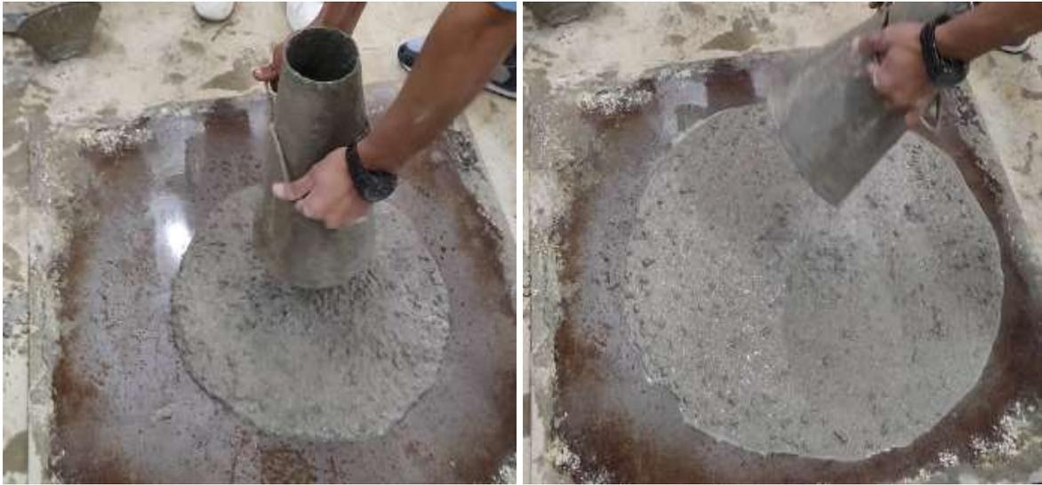
**Figure. III.2 Essai d'étalement de BAP.FP**
