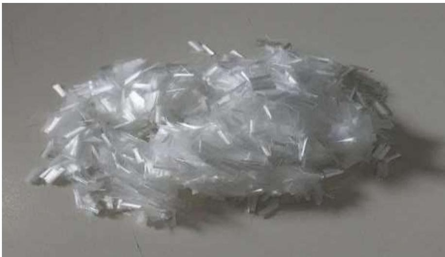
**Figure II.12 : Fibre polypropylène**
