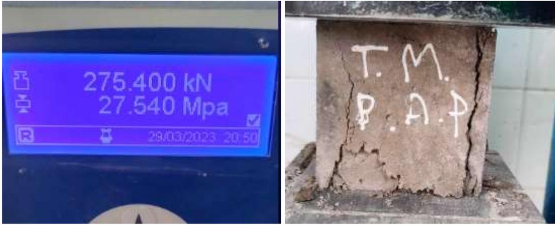
Figures III.26.Essai de compression pour BAPT exposé à haute température (600C°)
