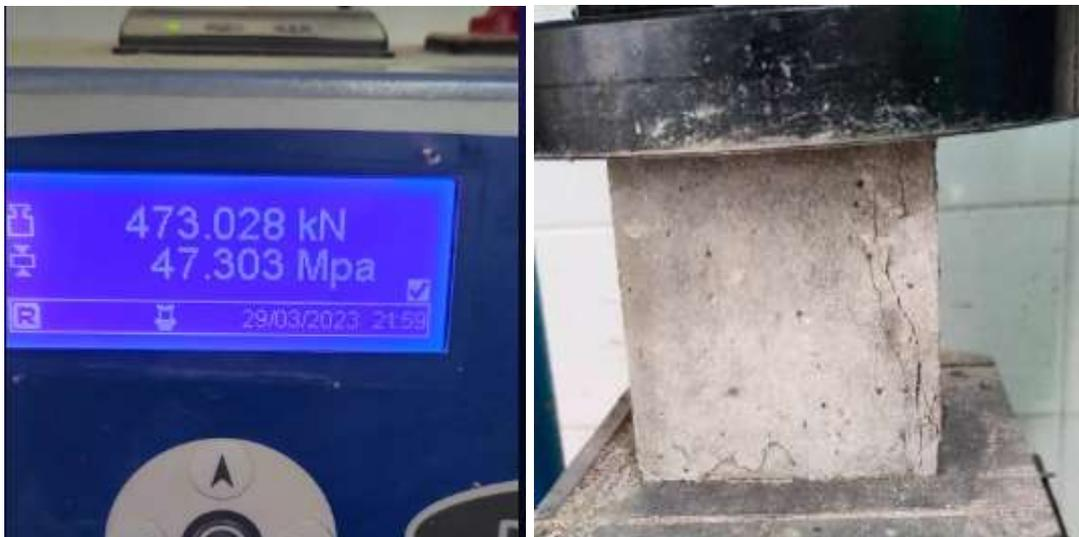
**Figures III.20. Mode de rupture et orientation des fissures de compression pour BAPP**
