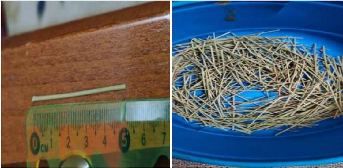
**Figure II.11 : Fibre végétales Halfa de 5 cm**
