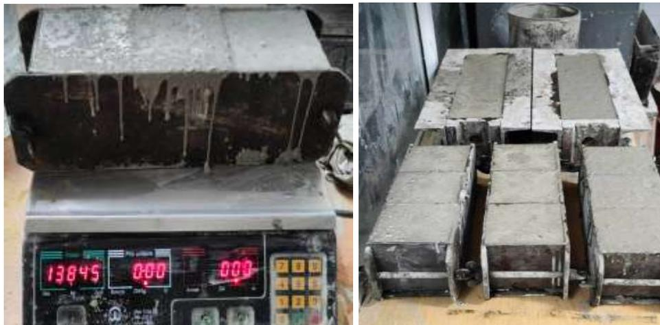
**Figure.III.13La masse volumique du béton autoplaçant**
