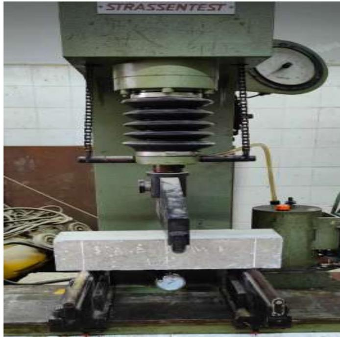
**Figure III.16: Dispositif expérimental pour l'essai de traction par flexion**
