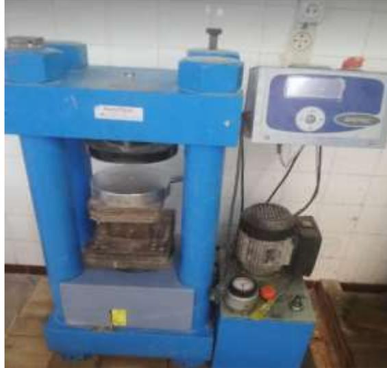
**Figure III.15 : Dispositif expérimental pour l'essai de compression**
