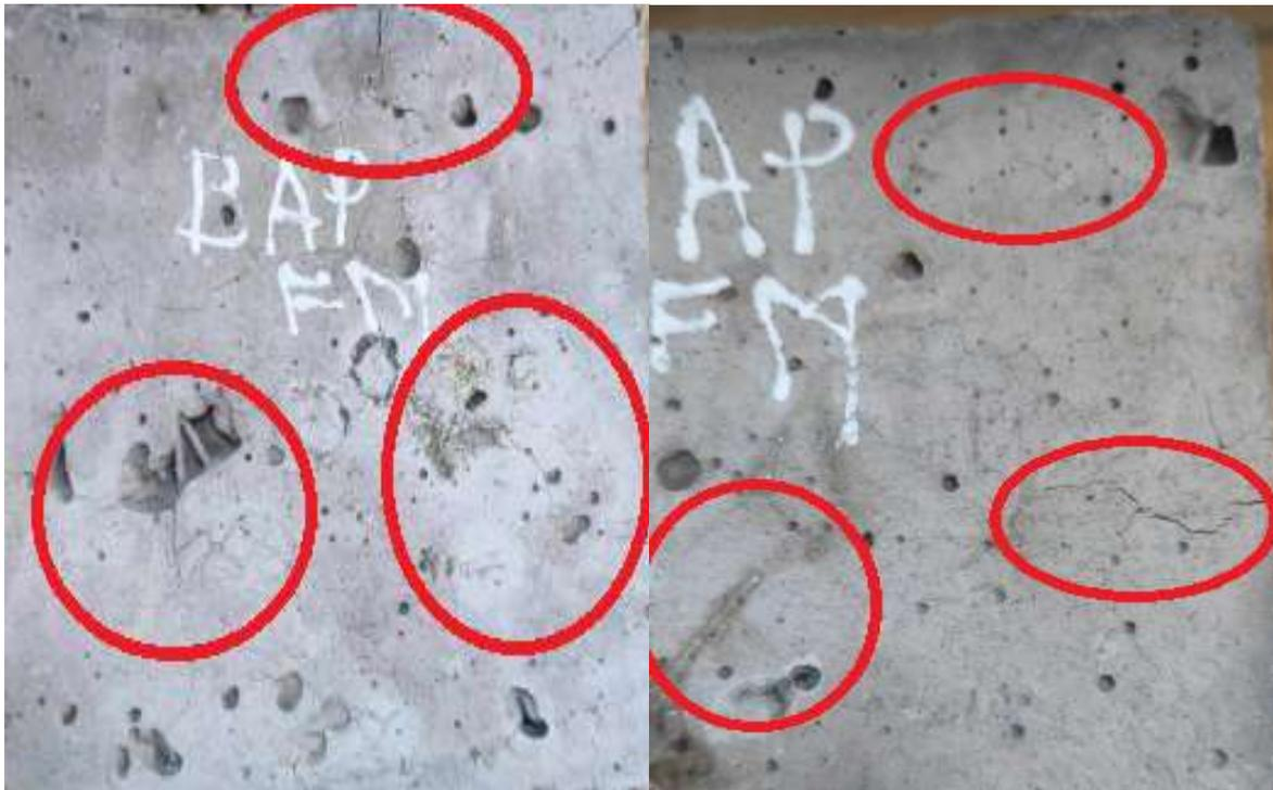
**Figure III.31.Fissuration dans les BAPFM**
