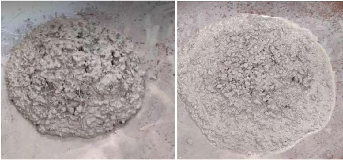
**Figure III.5.Essai d'étalement de B.A.P.F.V1**
