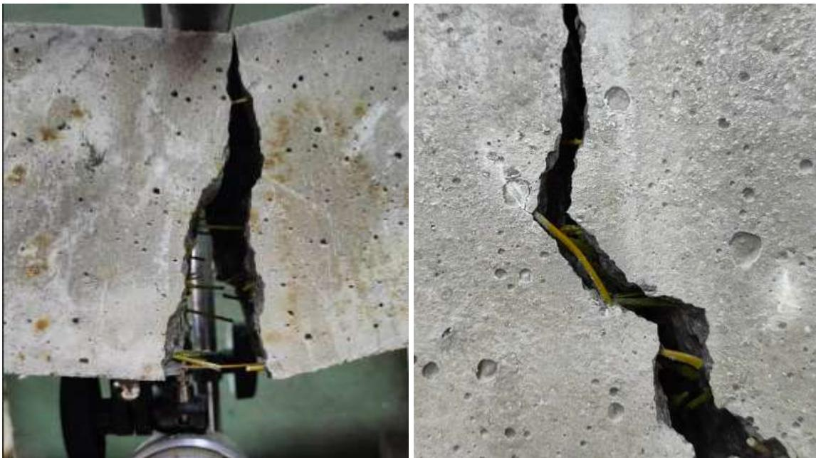
**Figure III.39: Comportement ductile des BAP.FV**
