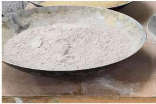
**Figure. II.7.Laitier granulé broyé pendant 10h.**
