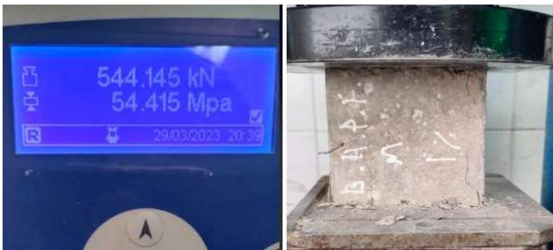
**Figures III.21. Mode de rupture et orientation des fissures de compression pour BAPM**
