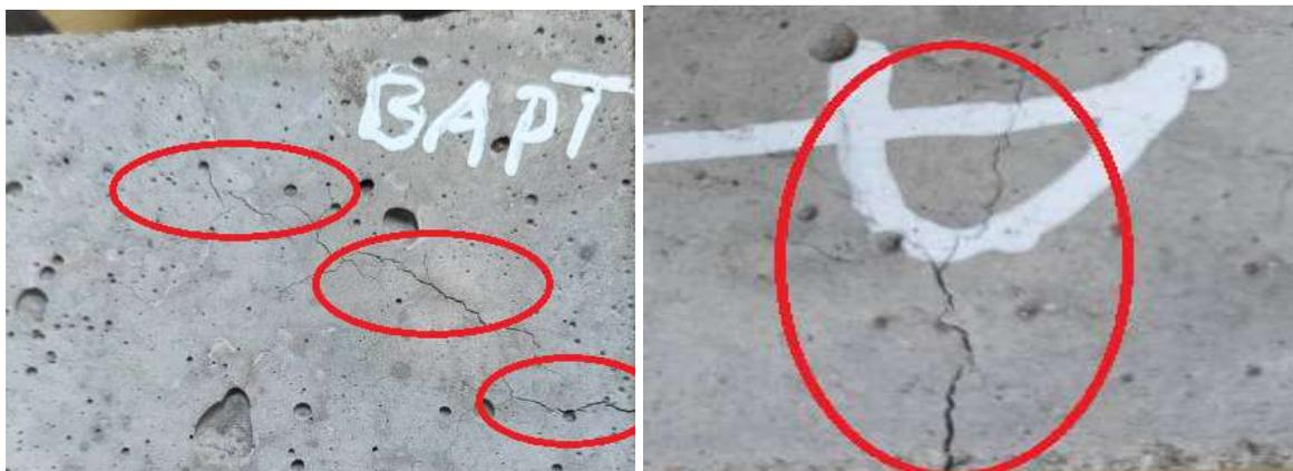
**Figure III.30. Fissuration dans les BAPT**
