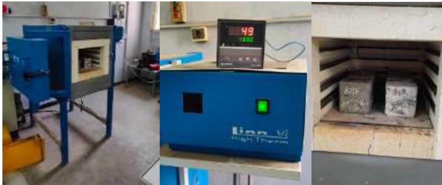
**Figures III.23 : Essai du comportement des BAP soumis à hautes températures.**
