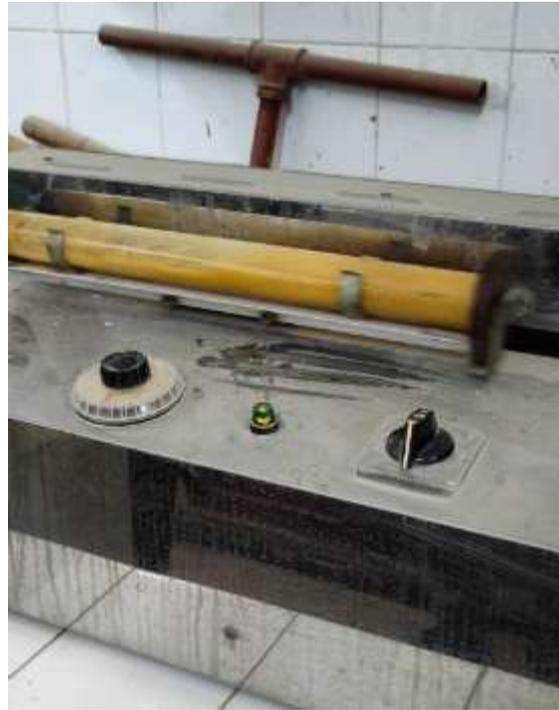
**Figure II.5 : Image de l'essai de l'équivalent de sable dune**
