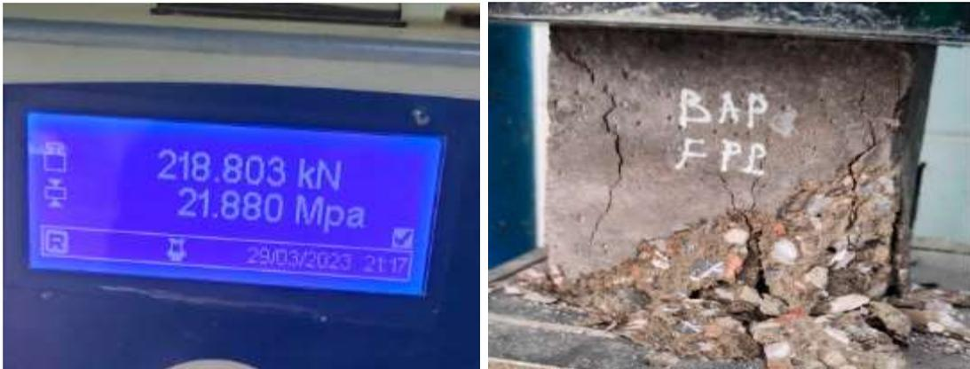
Figures III.27.Essai de compression pour BAPP exposé à haute température (600C°)
