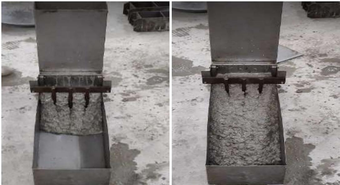
**Figure.III.8.Essai de boîte en L pour BAP.T**
