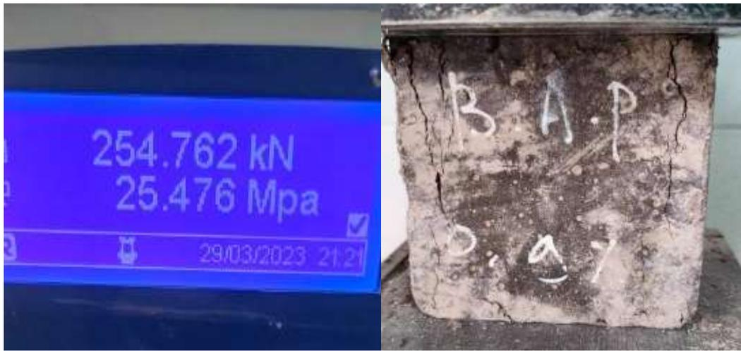
**Figures III.29. Essai de compression pour BAPV exposé à haute température (600°C)**
