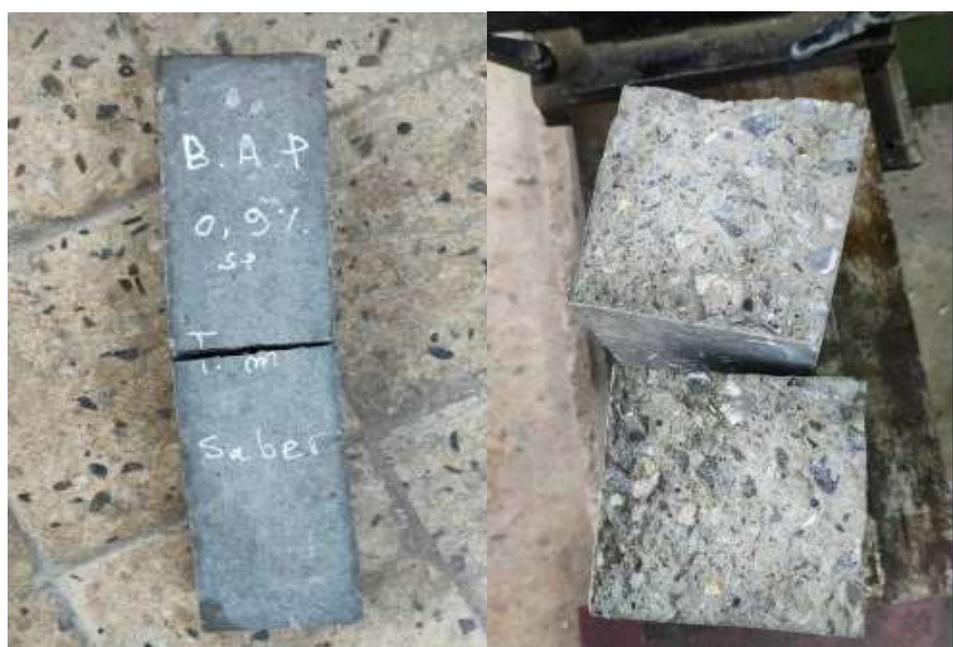
**Figure III.42: Mode de rupture en flexion des BAPT (témoin)**
