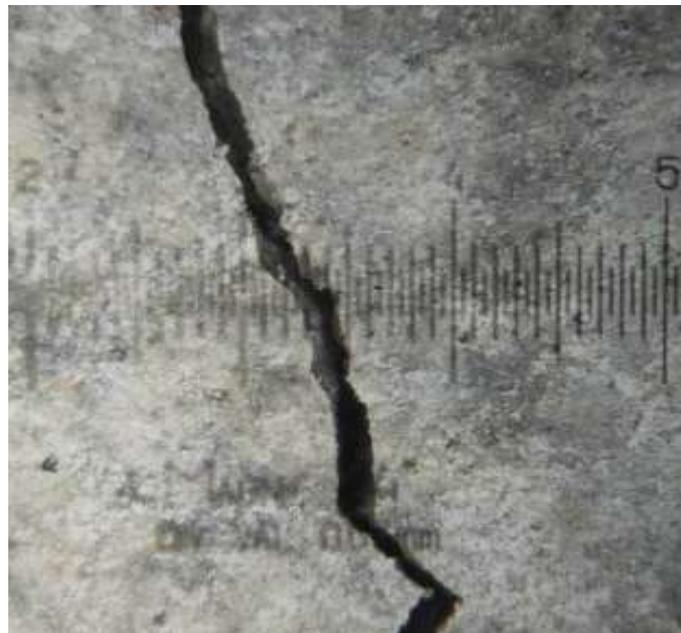
**Figure III.43. Mode de rupture en flexion des BAPFM**
