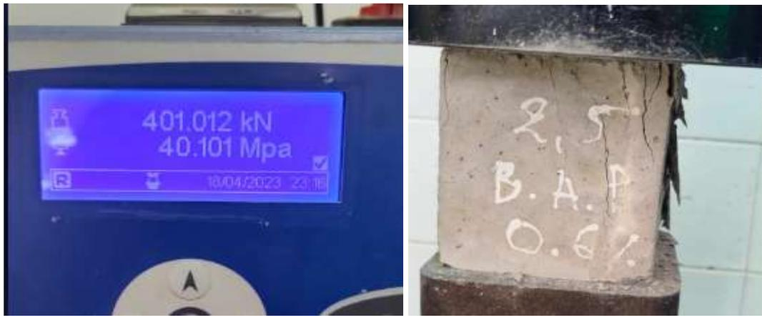
**Figures III.22. Mode de rupture et orientation des fissures de compression pour BAP.FV**
