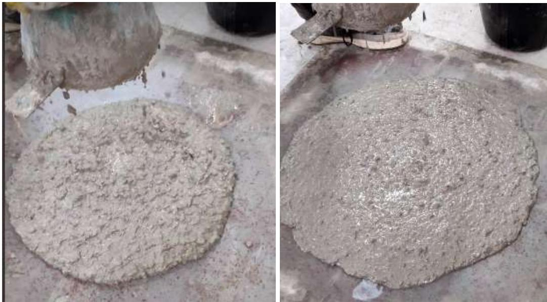
**Figure. III.6 Essai d'étalement de BAP.FV2**
