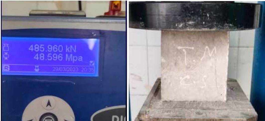
**Figures III.19. Mode de rupture et orientation des fissures de compression pour BAPT**
