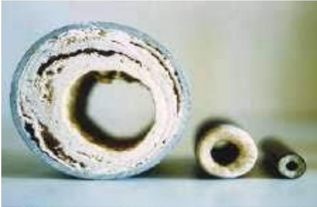
Figure II.10 : l'entartrage dans les circuits de refroidissement
