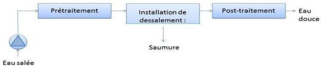
Figure II.2 : Schéma général de la technique du dessalement de l'eau salée
