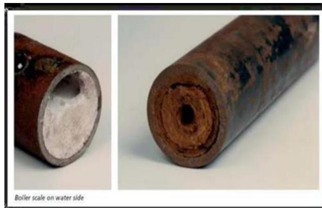
**Figure III. 17 :** Exemple de tartre dans un tuyau.
