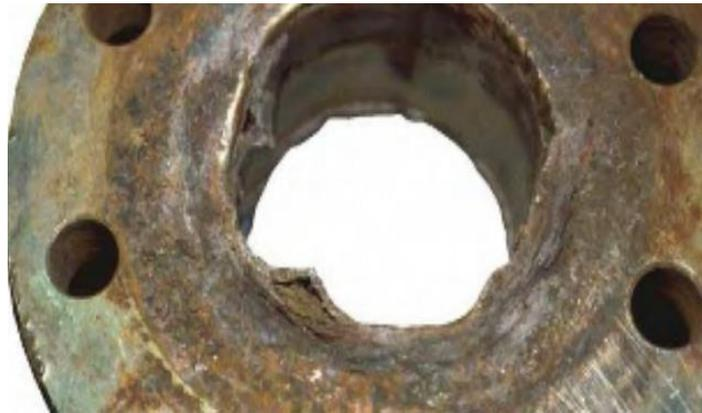
**Figure III.16** : Corrosion par crevasses
