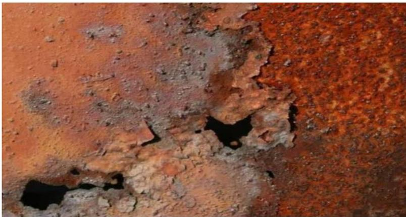
**Figure III.15** : Corrosion par piqûres
