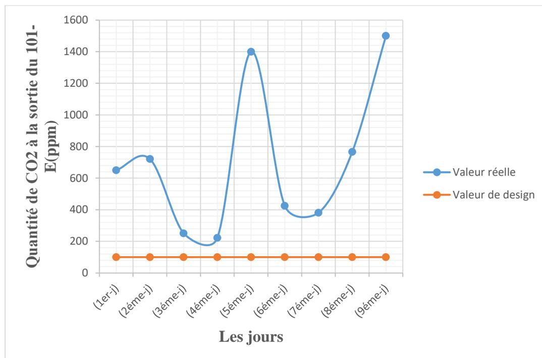
**Figure IV.5 :** Présentation graphique de la quantité de CO<sub>2</sub> à la sortie de l'absorbeur.
