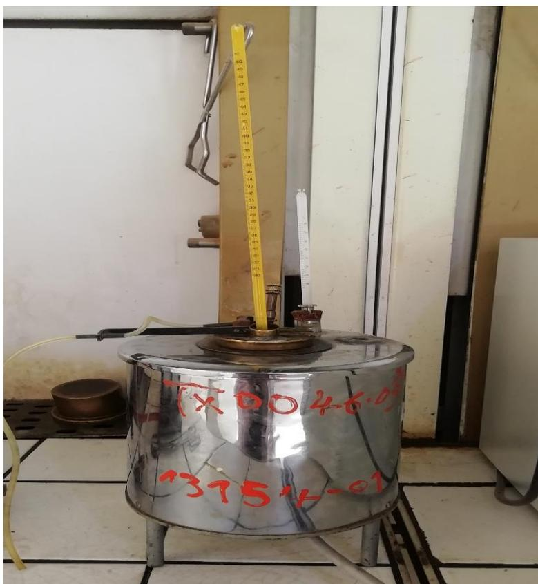
**Figure II.10 :** Appareil pour mesurer point d'éclair.
