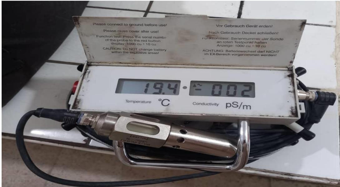
Figure II.14 : Appareil pour mesurer la conductivité.
