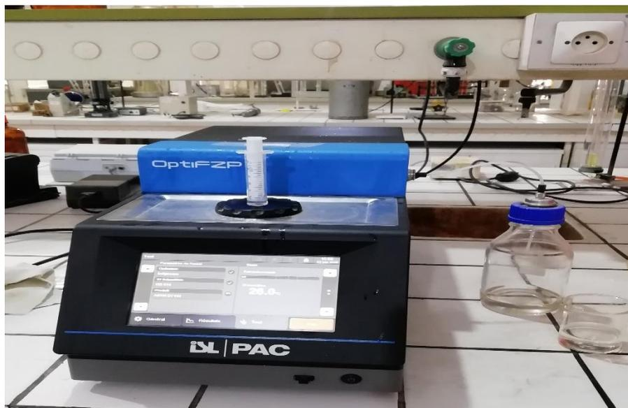
**Figure II.12** : Appareil pour mesurer le point de congélation.
