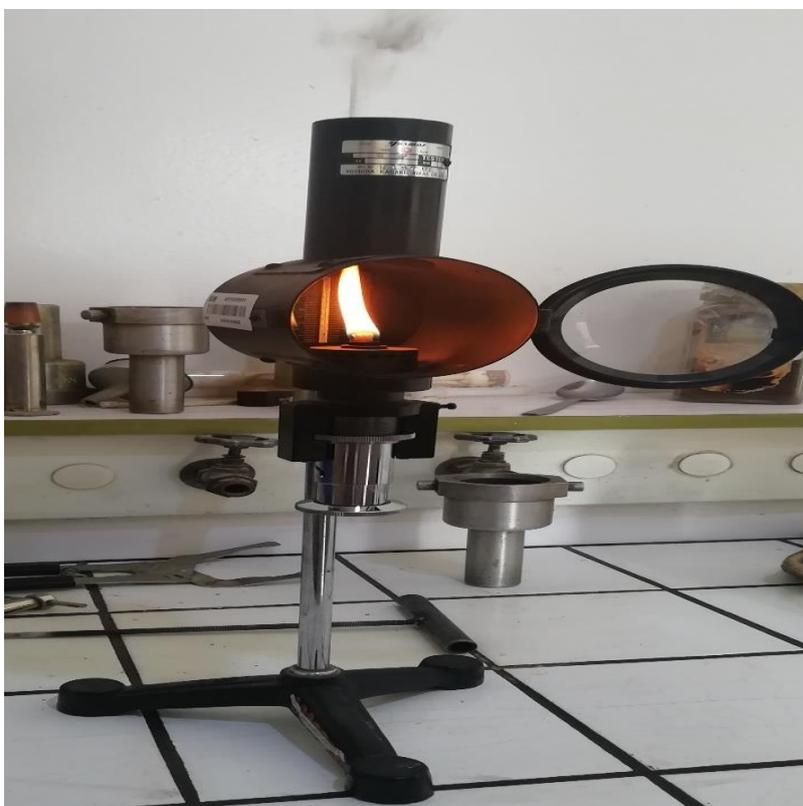
**Figure II.13 :** Appareil pour mesurer le point de fumée.
