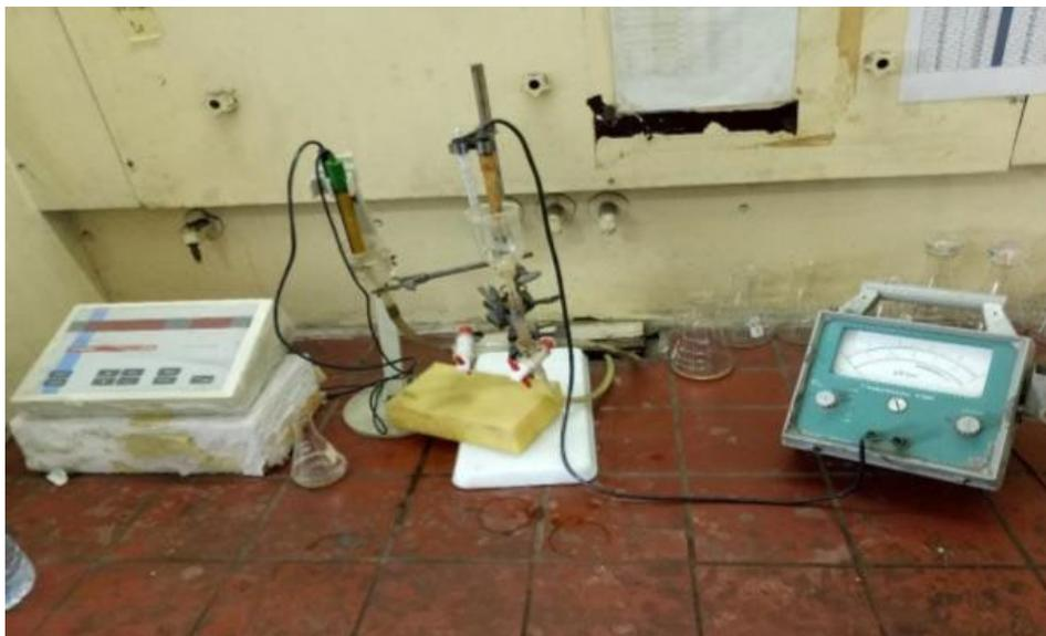
Figure III- 4: Couple pH- mètre/Conductimètre
