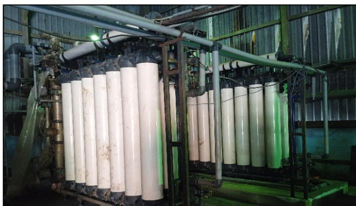
Figure II- 5: membrane de l'ultra filtration
