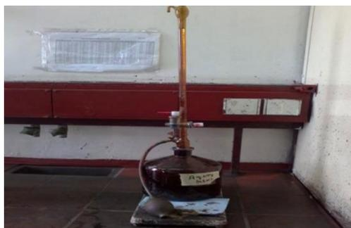
Figure III- 3: dosage volumétrique de Chlorure
