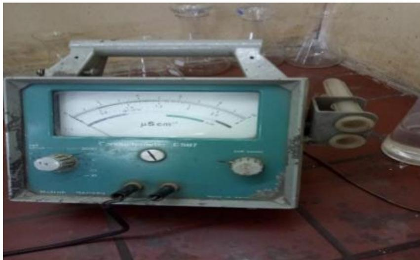
Figure III- 5: Conductimètre « E587 »
