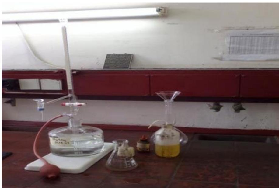
**Figure III- 1:** Dosage volumétrique du TA et TAC
