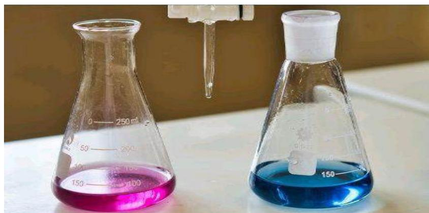
**FigureIV.2. : Détermination de TH solution avant titrage (rose) après titrage (bleu).**
