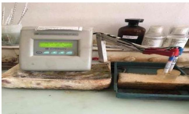
**Figure IV.5 : Conductimètre.**
