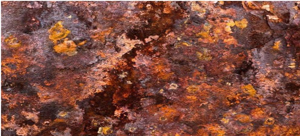
**Figure IV.1.** Corrosion sévère à l'intérieur de la colonne d'absorption.
