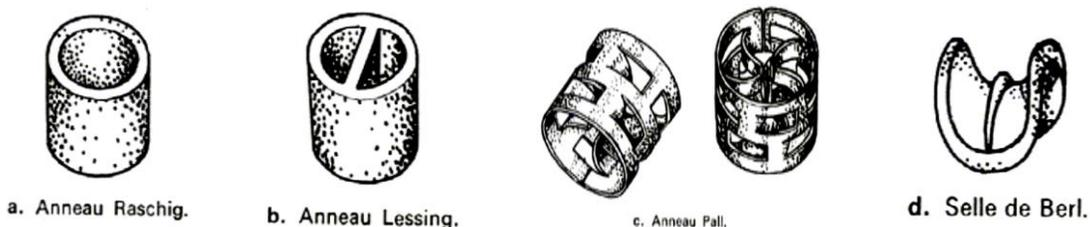
**Figure II.8.** Différents types de garnissages.
