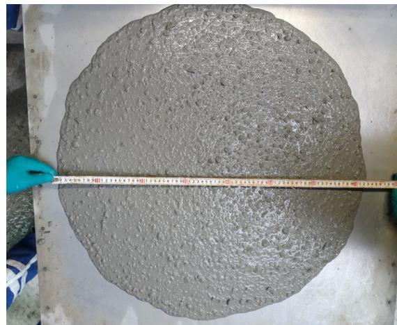
**Figure II.4.** Mesure du diamètre d'étalement au cône d'Abrams
