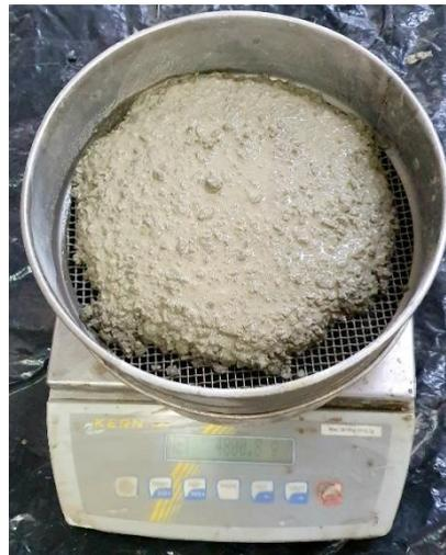
**Figure II.7.** Essai de stabilité au tamis.
