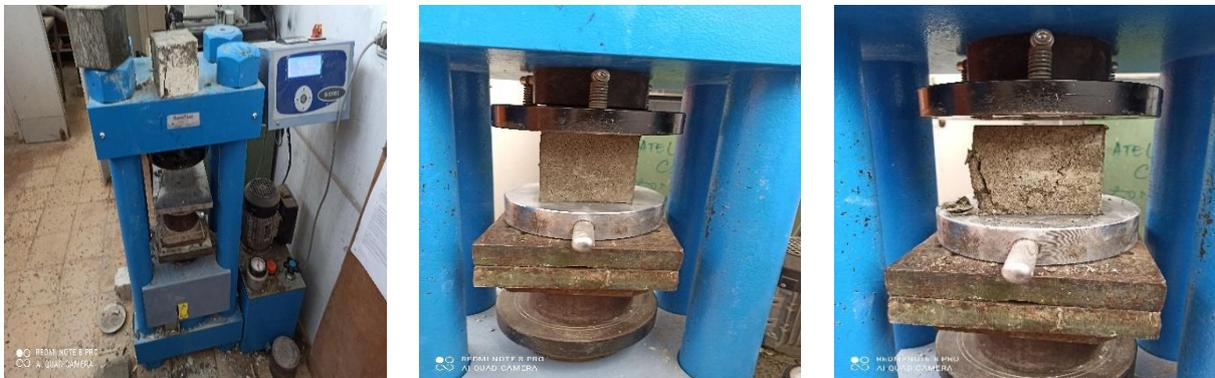
**Figure II.8.** Essai de compression
