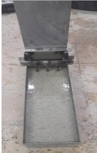
**Figure II.5.** Essai à la boîte en L (L-Box test).
