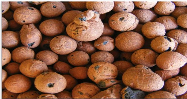
**Figure I.4.** Granulats d'argile expansée
