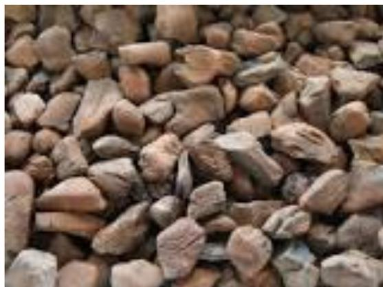
**Figure I.5.** Granulats de schiste expansé
