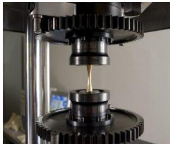
**Figure I .6:** L'essai et appareil de la fatigue
