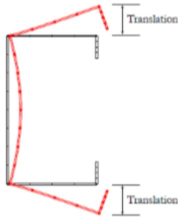
**Figure I .30:** Instabilité distorsionnelle d'une section en C uniformément comprimée
