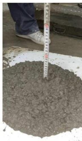
**Photo 3.2.b** – Affaissement important accompagné de ressuage observé après l'augmentation du dosage en superplastifiant de 0,5 à 0,8 (%) sur la composition B.II (avec la fraction 15/25)
