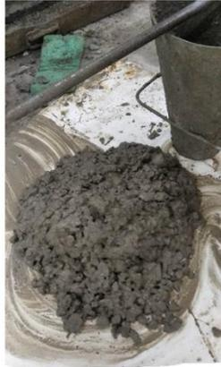
**Photo 3.3** – Affaissement mesuré après réduction du dosage en eau de 200 à 185 kg/m<sup>3</sup> (Absence de ressuage)
