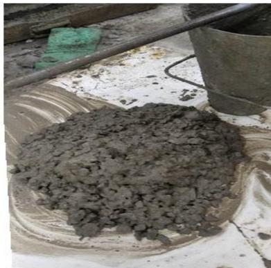
**Photo 3.4** – Affaissement mesuré après augmentation du dosage de la fraction (15/25) de 15 à 25 (%)
