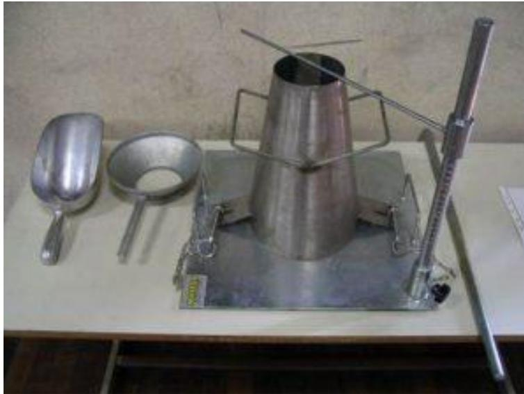
**Photo 2.7 - Matériel requis pour l'essai au cône d'Abrams.**
