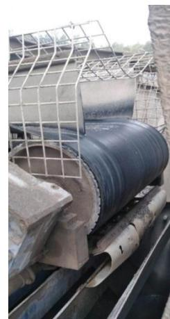
Figure 4.2 – Tapis balance pour granulats
