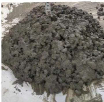
**Photo 3.1** – Affaissement important mesuré sur la composition B.I
