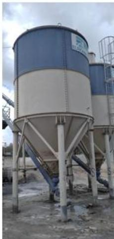
**Figure 4.4 – Silos à ciment**
