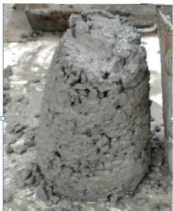
**Photo 3.2.a** – Affaissement faible mesuré avant l'augmentation du dosage en superplastifiant sur la composition B.II (avec la fraction 15/25)
