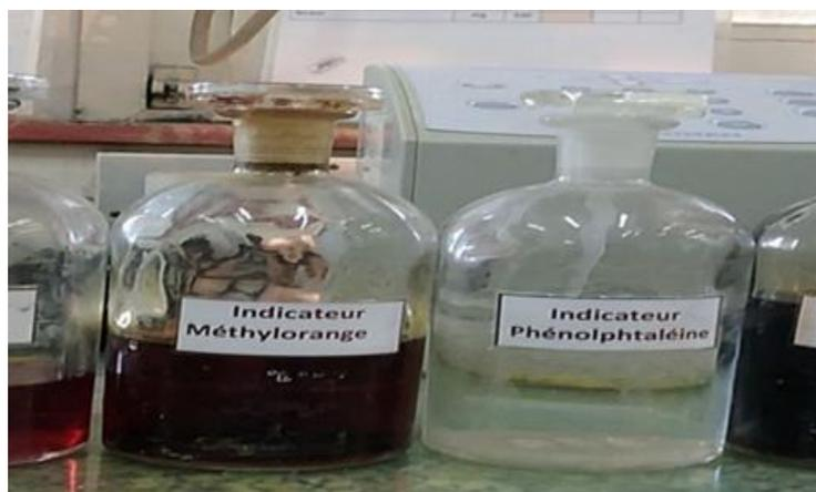
**Figure III.2.** Les indicateurs utilisés pour la détermination des titres de l'eau.
