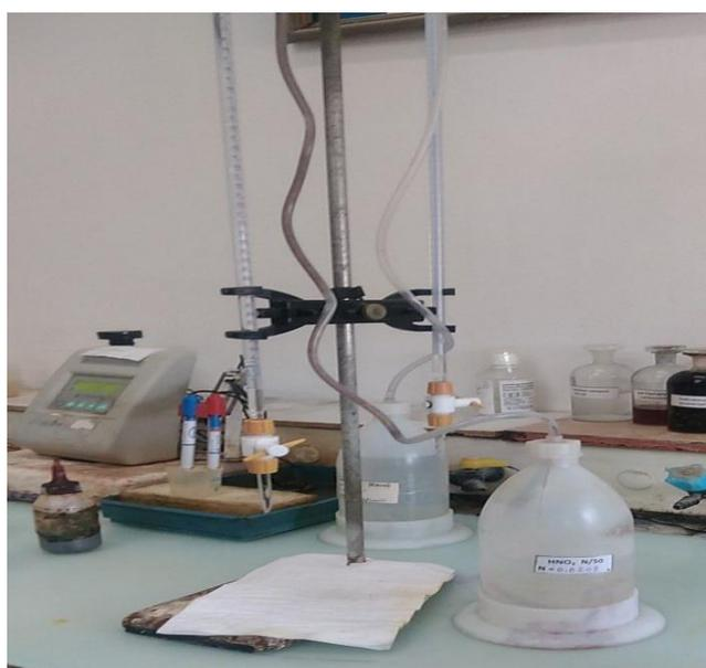
**Figure III.3.** Montage expérimental pour la détermination des titres de l'eau.
