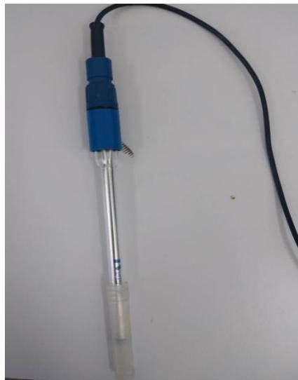
**Figure IV.7. Electrode auxiliaire.**
