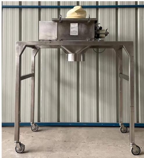
Figure III.17. Calibreur oscillant FREWITT.
