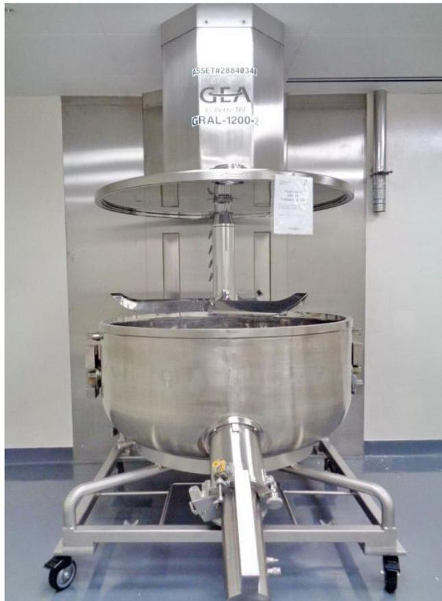
**Figure III.15.** Mélangeur-Granulateur COLLETTE.
