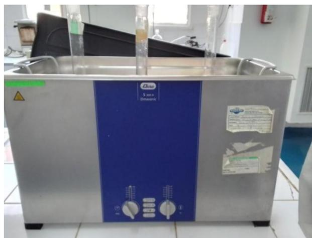
**Figure I.24** Les solutions dans le bain à ultrasons.
