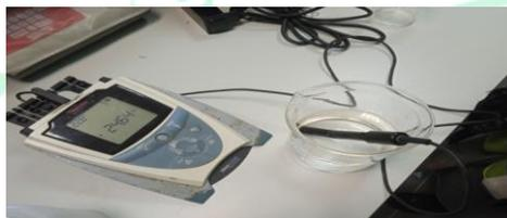
**Figure VI.1:** Mesure de la conductivité d'une solution d'eau osmosé de la sortie de première étape.
