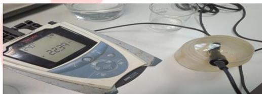
**Figure VI.2:** Mesure de la conductivité électrique d'une solution de la sortie de deuxième étape (eau douce).
