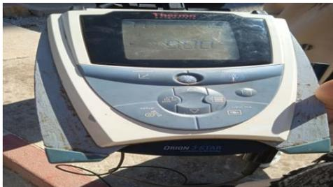
**Figure 07 :**Appareil de mesure de la conductivit .
