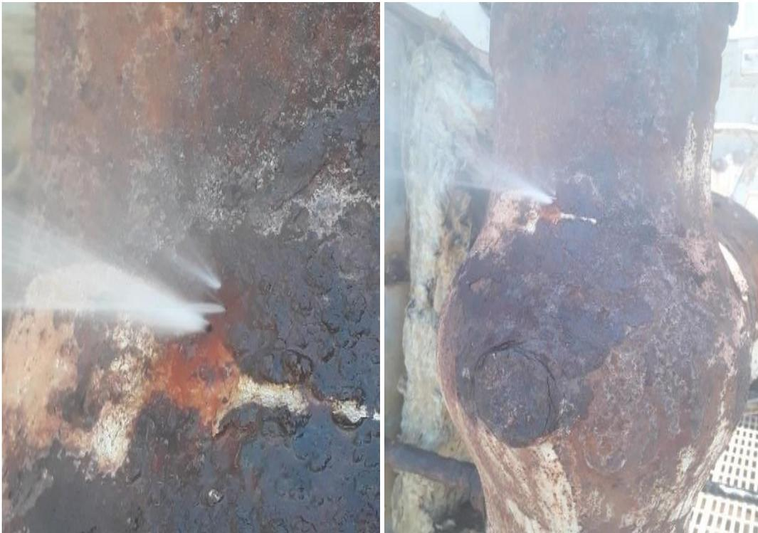
Fig 4. 2-Effet d'une corrosion par piqûre
