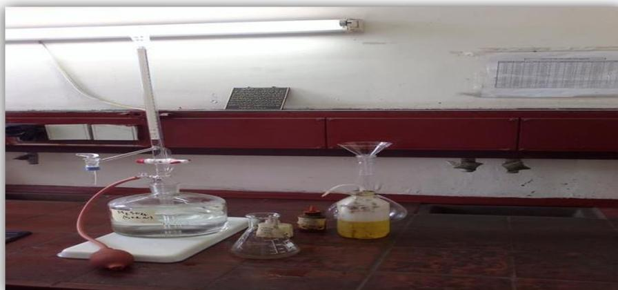
**Fig 7. 1-Dosage volumétrique du TA et TAC**
