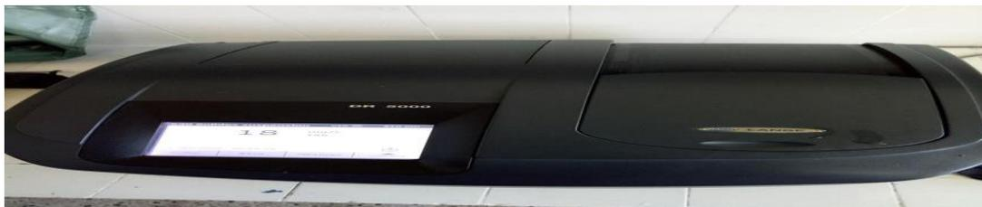
**Fig 7. 10-Spectrophotomètre "H Dr 5000" Dosage de la Silice**
