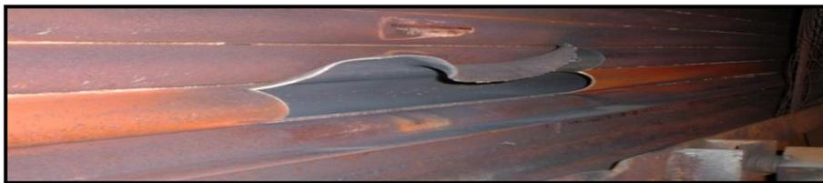
Fig 4. 11-phénomène de fluage causé par fatigue (éclatement d'un tube)
