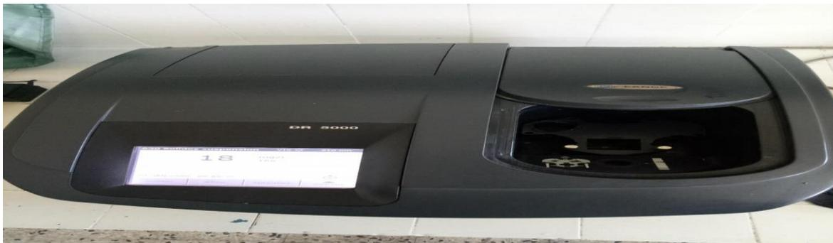
Fig 7. 8-Spectrophotomètre «H Dr 5000 »
