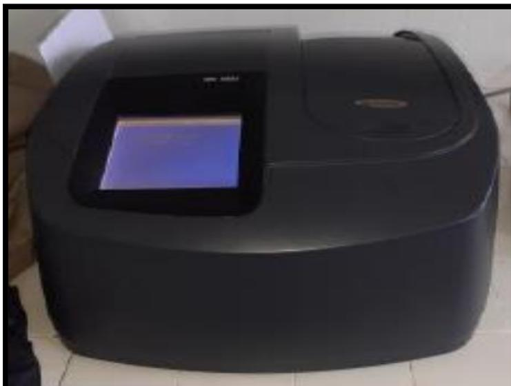
**Fig12** : Spectrophotomètre modèle HACHLANGEDR5000
