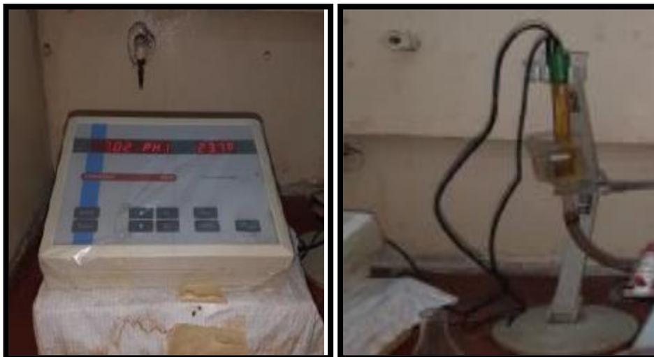
**Fig11** : Un pH-mètre contient deux électrodes (électrode de mesure et de référence) ;
