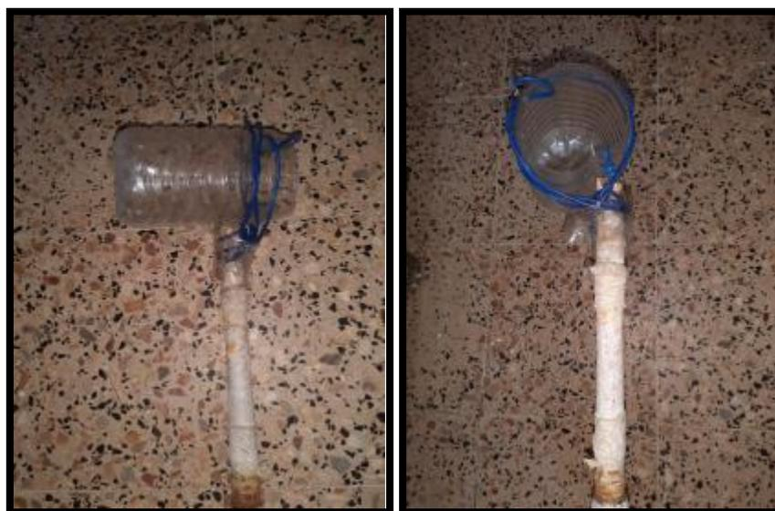
**Fig10** : La perche utilisée à l'échantillonnage
