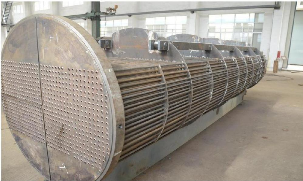
**Figure III.19:** Faisceau tubulaire d'un échangeur à tube et calandre [22].
