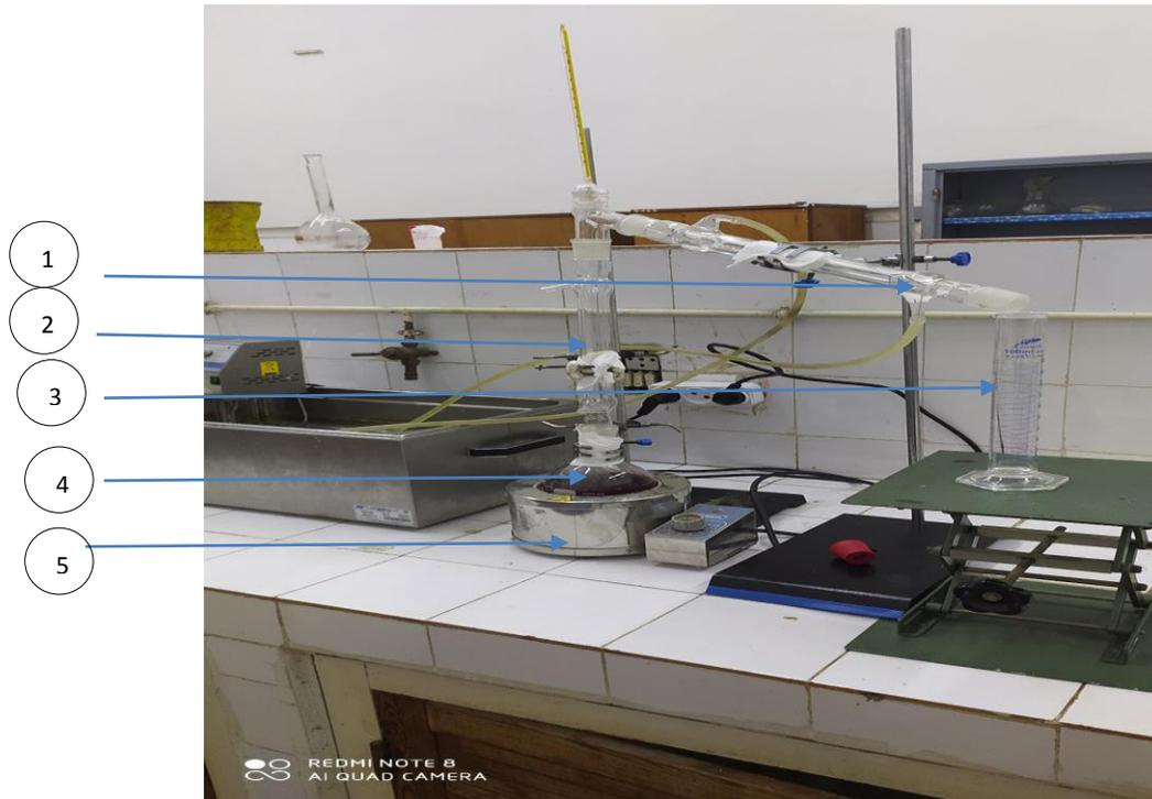
**Figure 2.8.** Montage de distillation.
