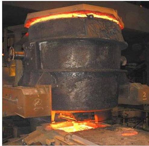
Fig. 13 : Poche de coulée alimentant un répartiteur
