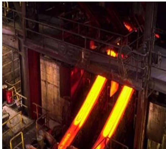
Fig. 18 : Refroidissement secondaire simultané de deux brames
