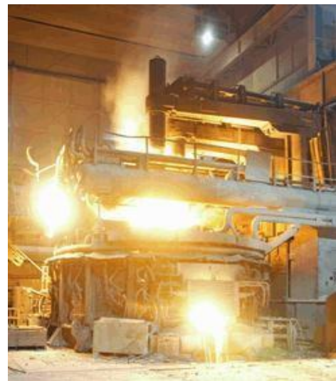
Fig. 8 : Four électrique dans une aciérie
