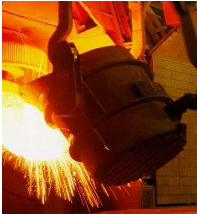
Fig. 4 : Convertisseur à oxygène
