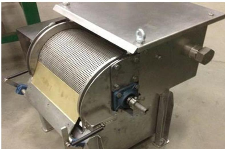
**Figure II.2 : un tamis rotatif pour les eaux usées**
