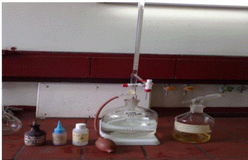
**Figure IV.4:** Dosage volumétrique du  $T_{Ca^{++}}$
