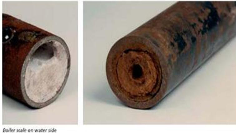
Figure III.4 : Entartrage dans les chaudières
