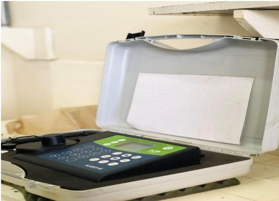
**Figure IV.12** : Turbidimètre AL450T-IR
