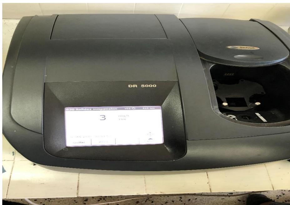
Figure IV.11 : Spectrophotomètre « H Dr 5000 » dosage de l'acide ortho phosphorique
