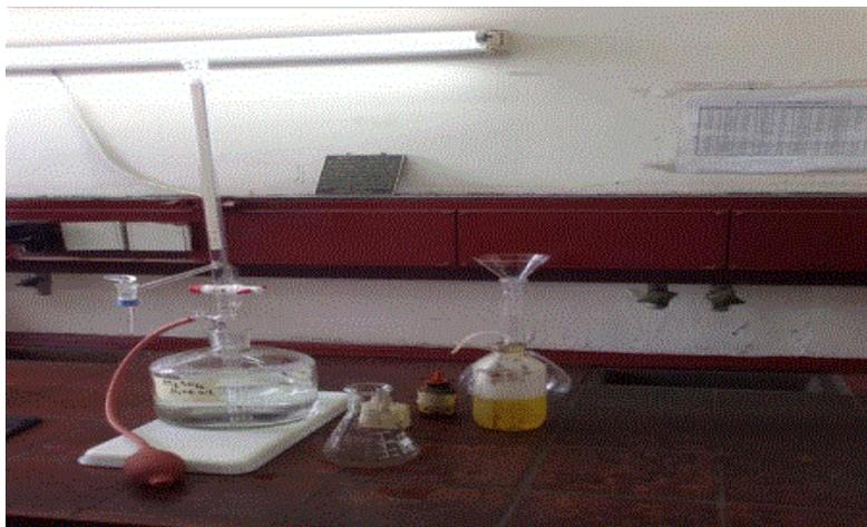
**Figure IV.2 :** Dosage volumétrique du TA et TAC
