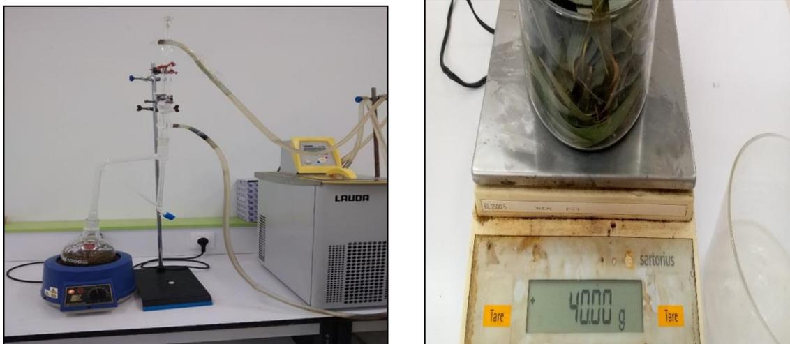
Figure (III.10) : Montage d'hydro-distillation
