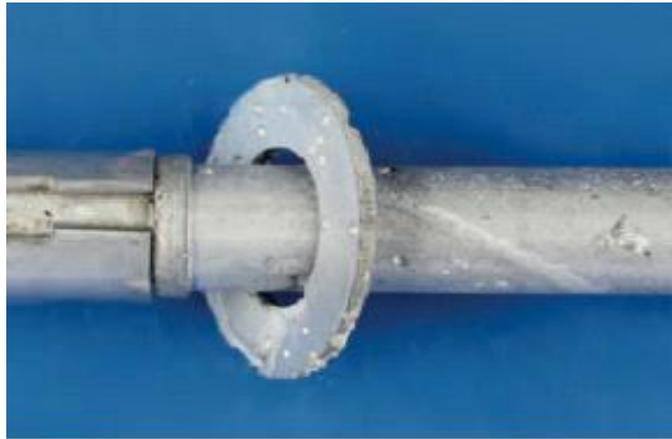
**Figure(II.4):** Exemple de corrosion par piqûre sur un produit en acier inoxydable[15]
