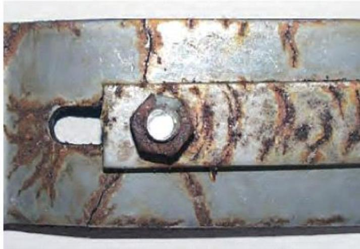
**Figure(II.8):** Corrosion sous contrainte [15]
