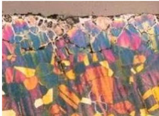
**Figure(II.5):** Corrosion inter granulaire d'un inox par HCl [14].
