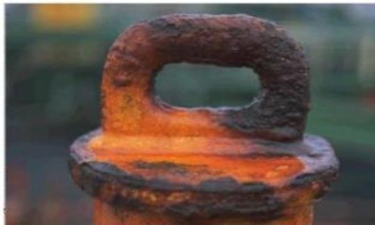
**Figure II.10.** Corrosion généralisé
