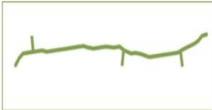
Figure I.6 : Structure de polyéthylène haute densité PEHD
