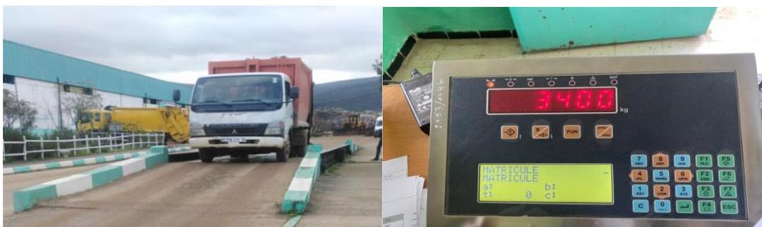
Figure II.17 : Le processus de pesage des camions
