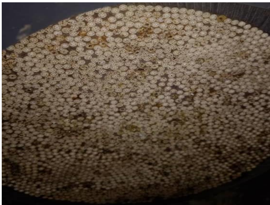
Figure II.13. L'intérieure d'une membrane d'ultrafiltration.
