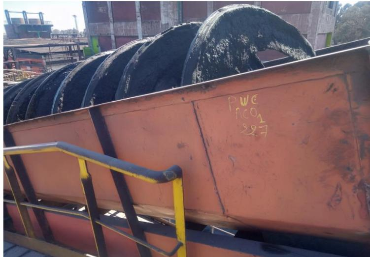
Figure 13 : vis sans fin pour la séparation de boue (partie lourde)
