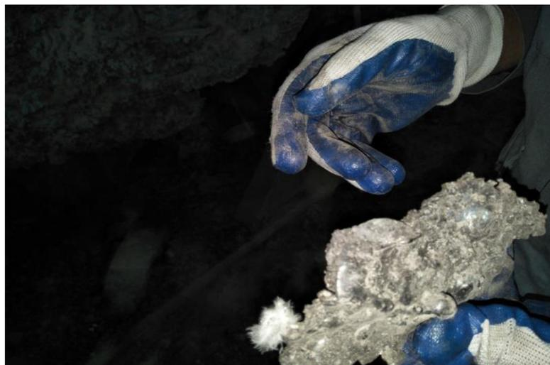
Figure 16 : Un échantillon de scorie d'une poche à acier
