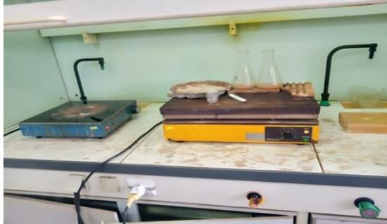
Figure 25 : la plaque chauffante (bain de sable)
