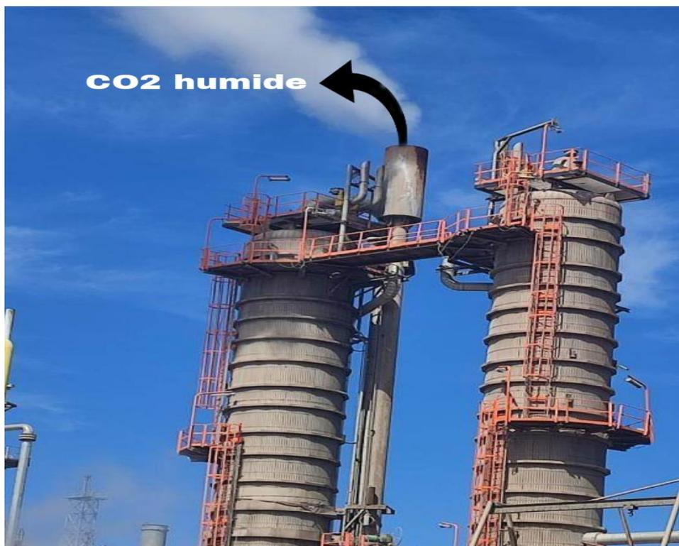
**Figure III.2:** L'émission du CO<sub>2</sub> au niveau de strippers 102EA/B (section décarbonatation) à l'unité d'Ammoniac Fertial –Annaba.
