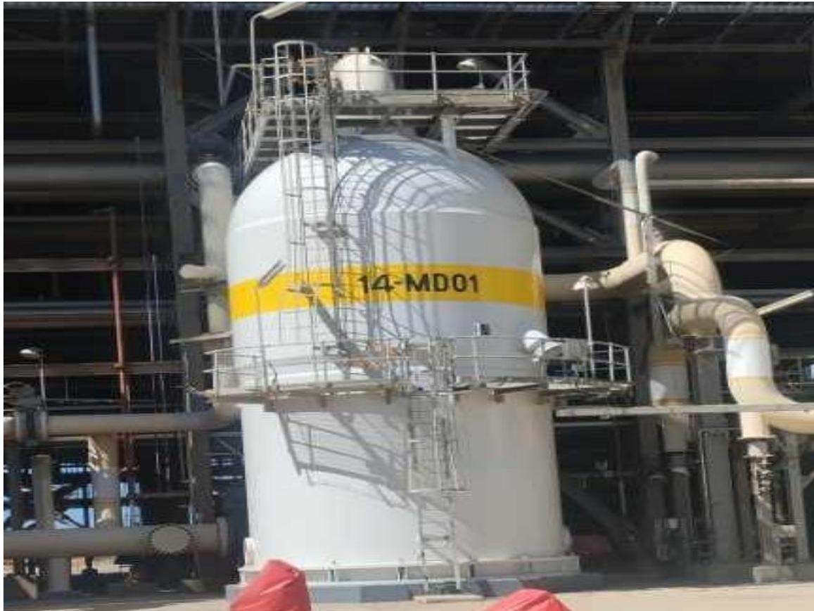
Figure II.9 : Démercuriseur de GN dans le complexe de GNL01K Skikda
