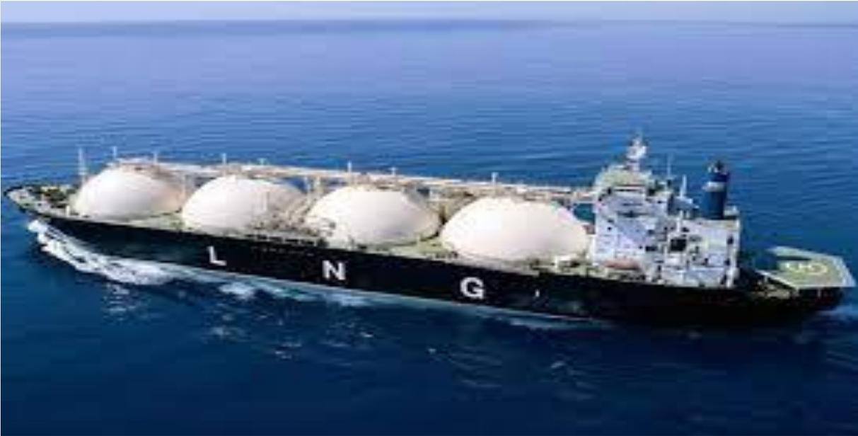
**Figure I.3 :** Méthanier pour transport du GNL.
