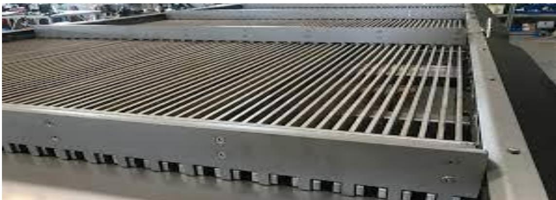
Figure I.5: Dégrilleur.
