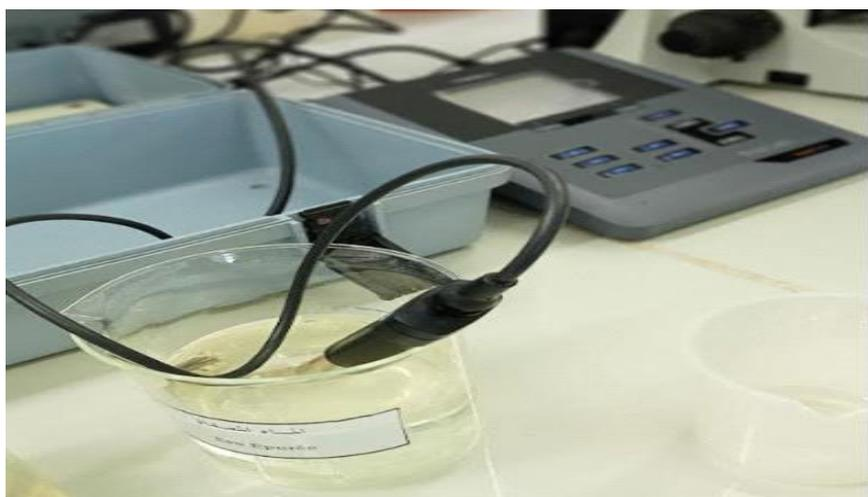
Figure IV .4 : Mesure CE par conductimètre.
