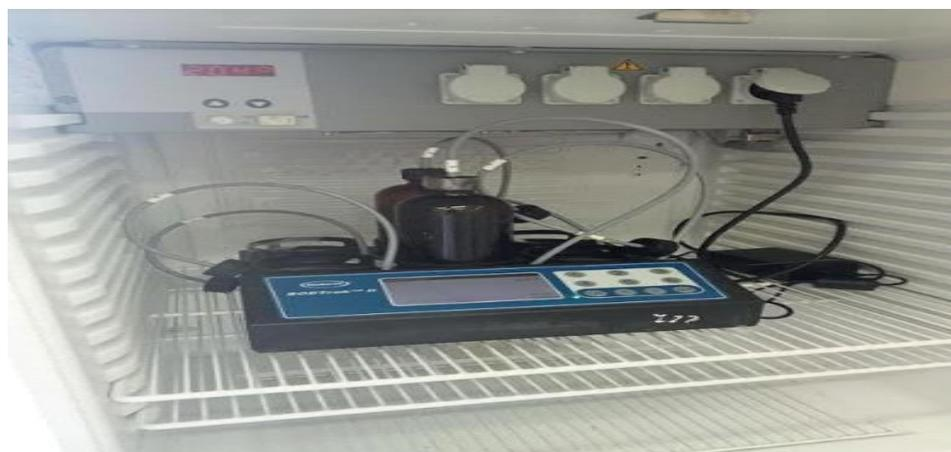
Figure IV .5 : Mesure DBO<sub>5</sub> par DBO-mètre.
