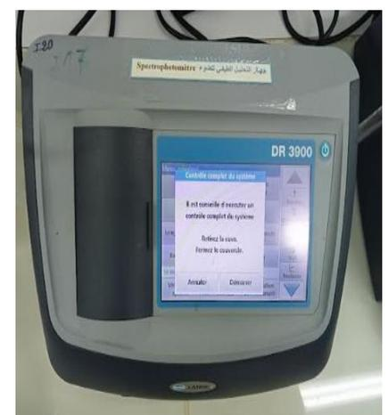
Figure IV.8: Mesure DCO par Spectrophotomètre.
