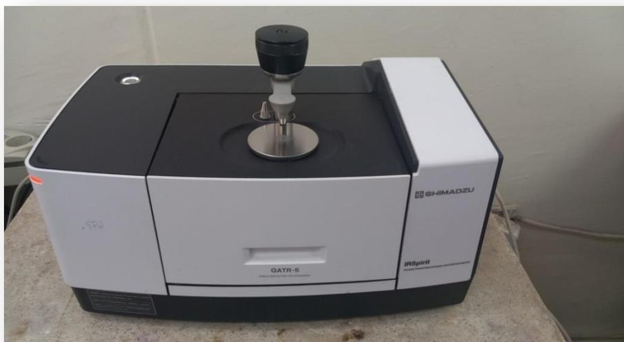
*Figure I.9 : Spectrophotomètre IRTF.*
