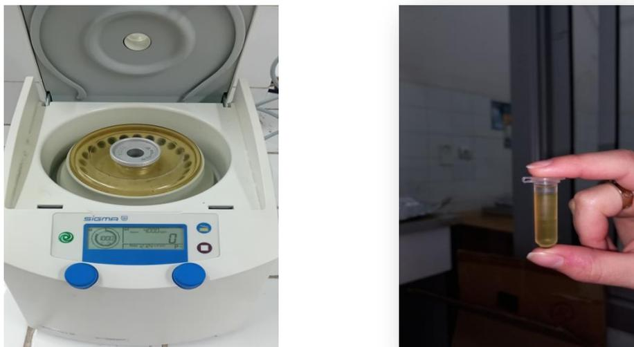
*Figure II.3 : Echantillon représentatif du mélange après centrifugation.*
