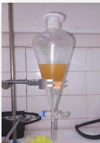
*Figure II.4 : Remonté du biodiesel après lavage à l'eau.*
