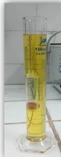
*Figure II.14 : Mesure de la densité.*
