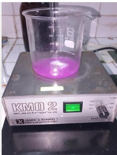
*Figure I.10 : Mesure de l'indice d'acide.*
