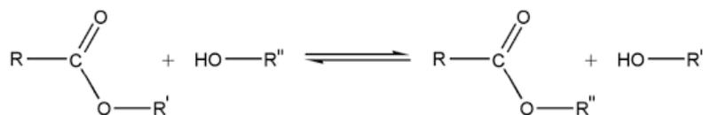
Figure I.5 : Réaction de transestérification.
