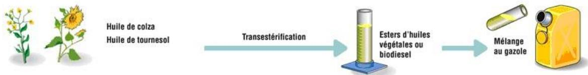
*Figure I.1 : Les Esters Méthyliques d'Huile Végétale (EMHV) ou biodiesel [2].*
