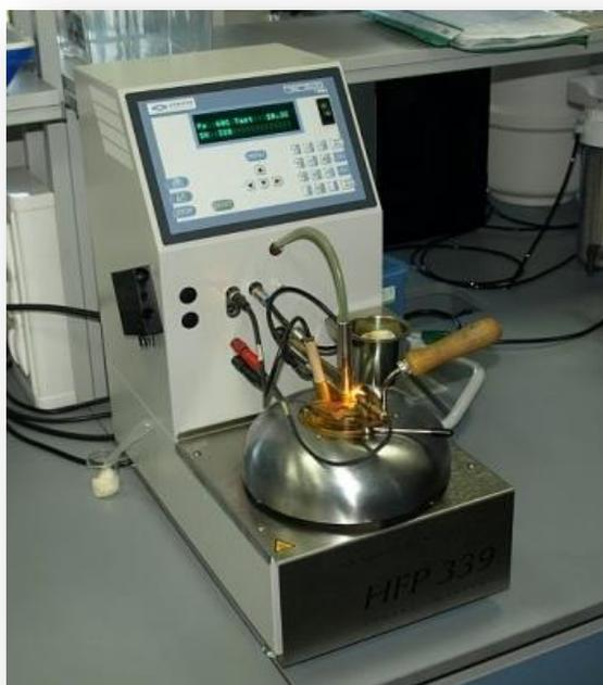
*Figure I.11 : Appareil de mesure du point d'éclair.*
