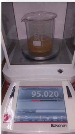
*Figure II.5 : Mesure de la quantité en ester alkylrique obtenu.*
