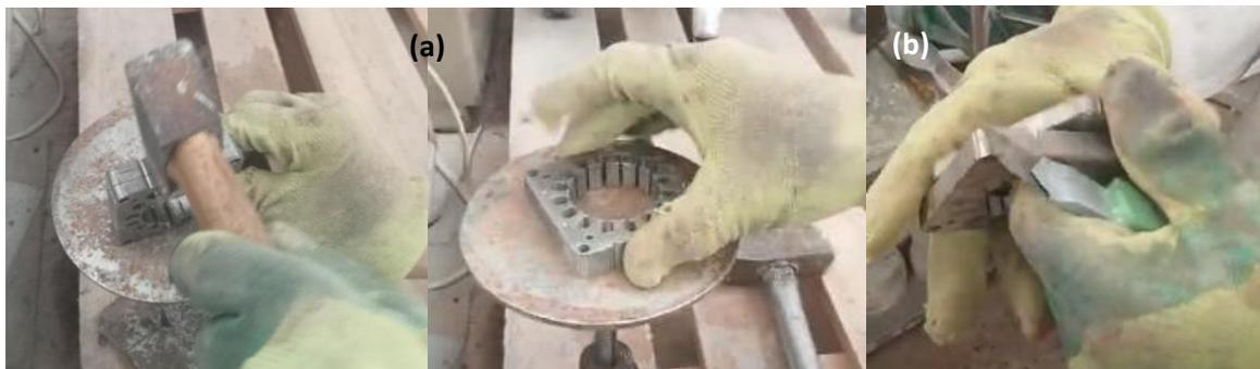
**Figure II.4.** Désolidarisations d'empilement de plaquette de fer : **(a)** vue de profile et **(b)** vue de face.
