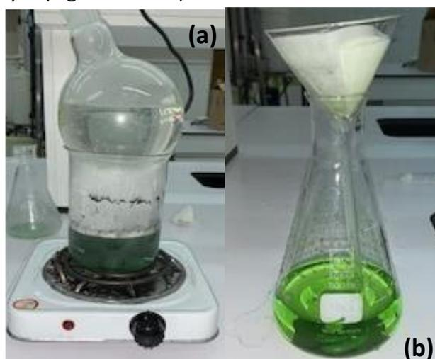
**Figure II.11.** Séparation de la solution de  $FeSO_4$  (a) refroidissement de la solution du  $FeSO_4$  et (b) filtration de la solution de chlorure de fer.
