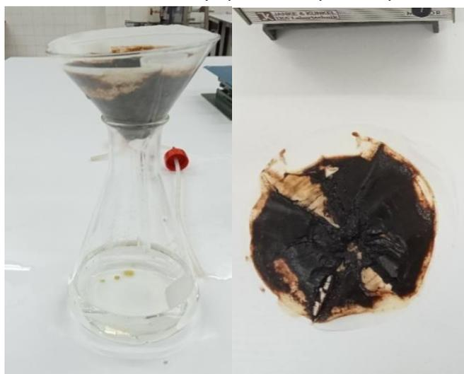
**Figure II.15.** Filtration de la magnétite.
