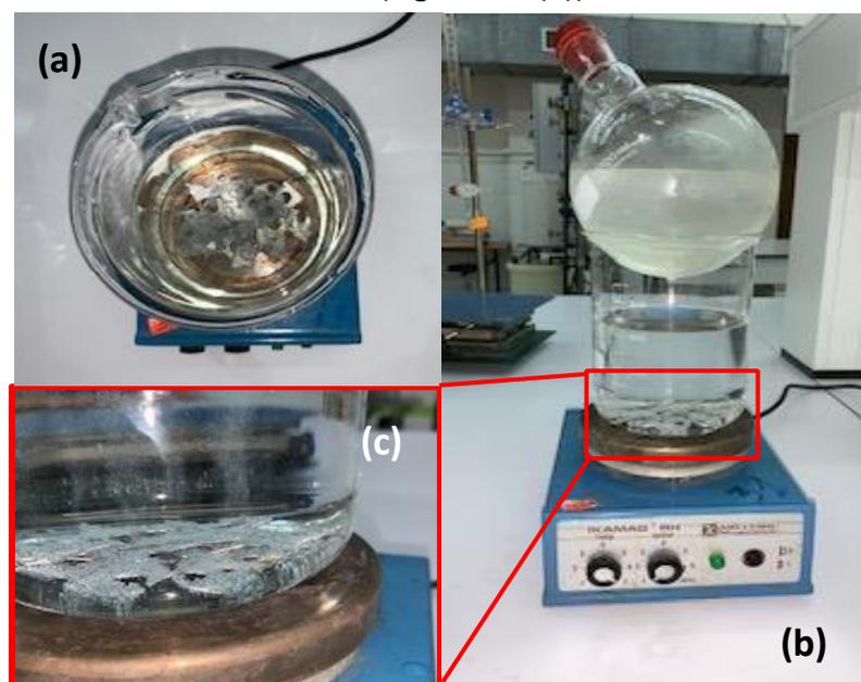
**Figure II.6.** Procédure de synthèse de  $\text{FeSO}_2$  : **(a)** initiation de la réaction, **(b)** chauffage de la réaction et **(c)** formation de bulles d'hydrogène.
