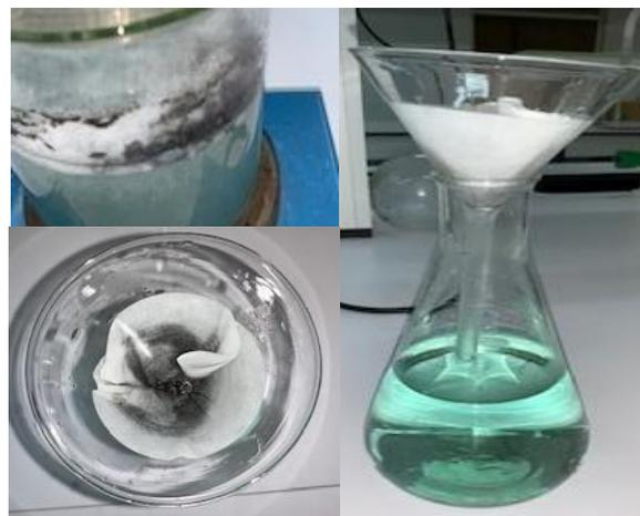
**Figure II.8.** Filtration de la solution de  $FeSO_4$ .
