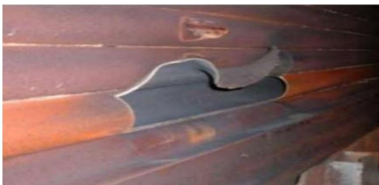
**Figure n° 15 : Phénomène de fluage causé par corrosion par fatigue. (Éclatement d'un tube)**
