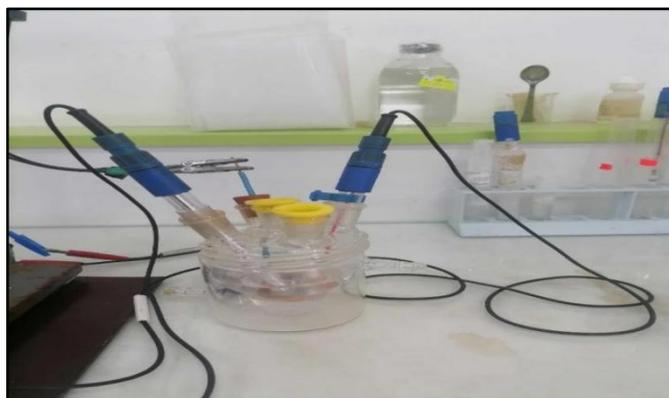
**Figure n°25: Cellule électrochimique réalisé à trois électrodes**
