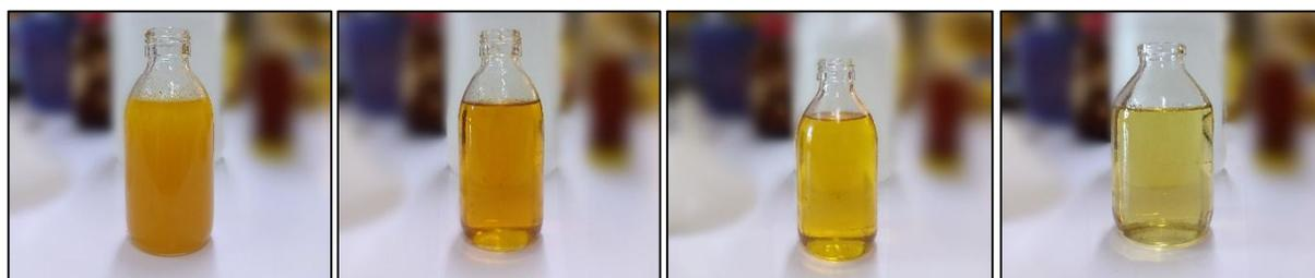
**Figure 19** : les quatre échantillons d'huile au cours du raffinage chimique.
