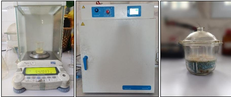
**Figure 23** : Détermination de l'humidité
