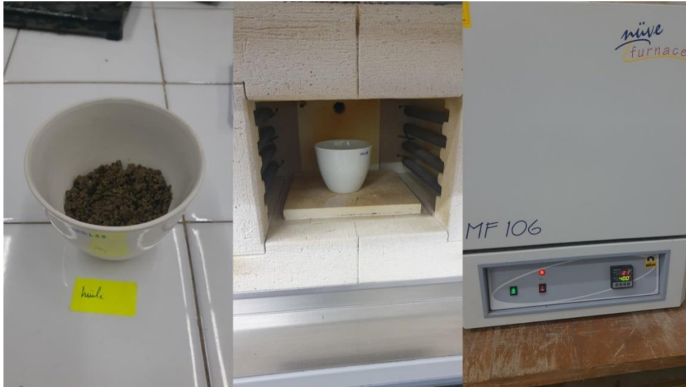
Figure 35 : L'incinération du sable contaminé par les huiles
