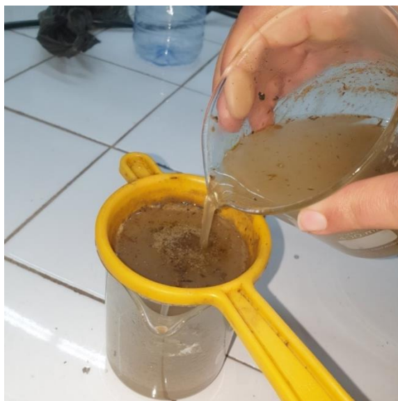
Figure 32: Filtration de SCH après lavage
