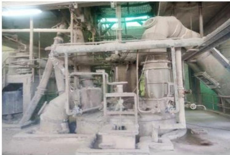
**Figure III.3** : Mélangeur pour la préparation de la bouillie
