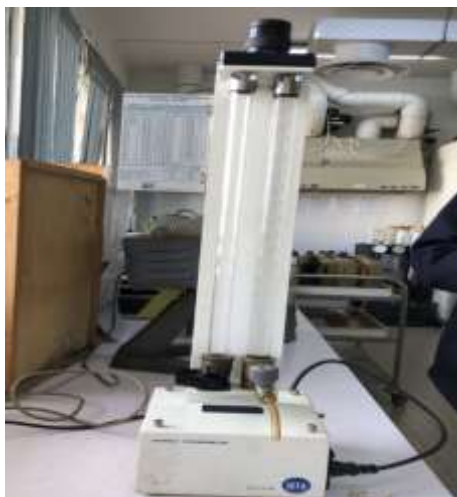
Figure III.5 : Appareil pour détermination de la couleur SAYBOLT.
