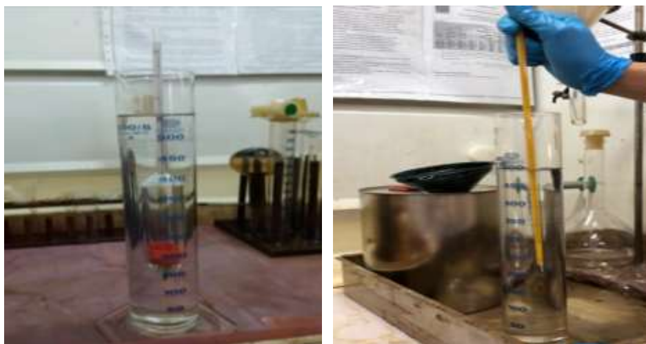
Figure III.2 : Mesure de la température et de la masse volumique.
