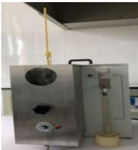
Figure III.4 : Appareil de la distillation ASTM.
