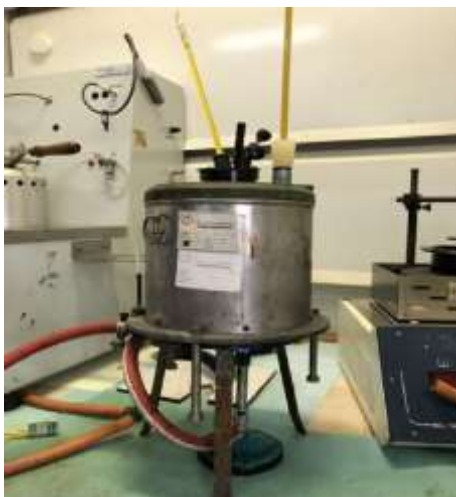
Figure III.3 : Appareil pour détermination de point d'éclair ABEL.
